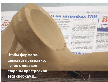
...а с тыльной — фиксируется зажимами
