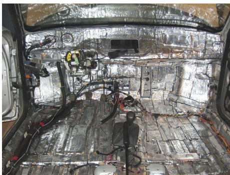
Первый слой виброизоляции («Бимаст Бомб»)
