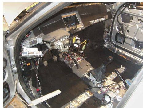
Второй — шумоизоляционный (AA 25)
