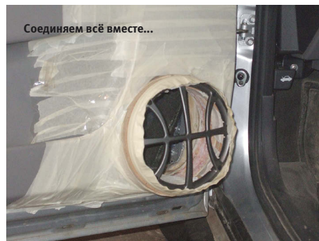
И выклеиваем стеклопла- стиковую оболочку
