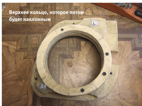
Зазор между кольцами заполняется пеной...
