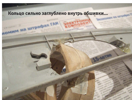
Отверстие в пластике обшивки задаёт форму «выборки» перед динамиком
