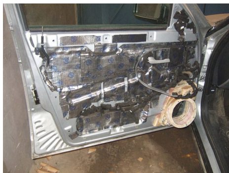
Дверь после полной обработки и заделки технологических окон
