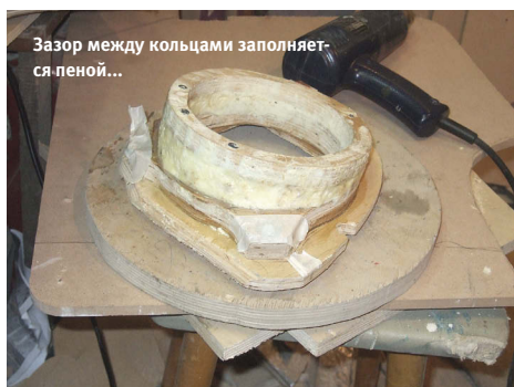
Затем усиливается шпатлёвкой со стекловолокном
