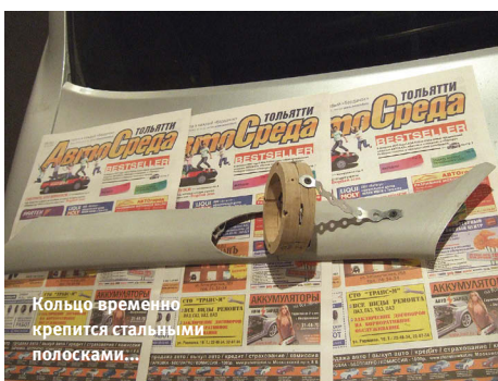
Поэтому особенно важно, чтобы оно потом не упёрлось в металл стойки
