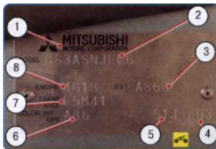
Рис. 1.6. Табличка идентификационных кодов автомобиля: 1 - завод-изготовитель; 2 - код модели автомобиля; 3 - код наружного оснащения; 4 - код типа конструкции кузова; 5 - код внутреннего оснащения; 6 - код лакокрасочного покрытия; 7 - модель коробки передач; 8 - модель двигателя
