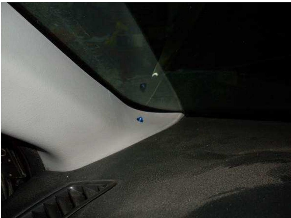
**снимаем щиток приборов, сначала фальш панель щитка –два самореза**
