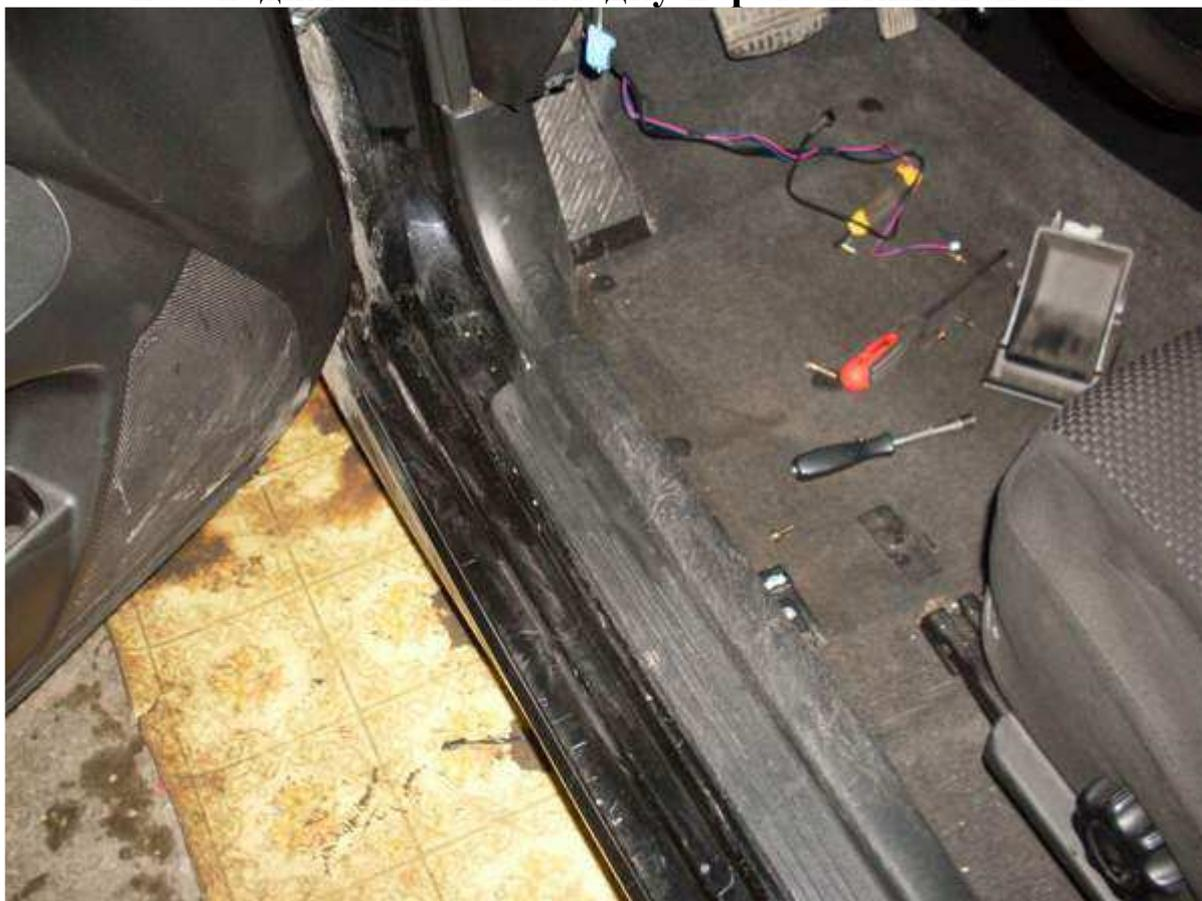
**получаем доступ к жгуту проводов в пороге
