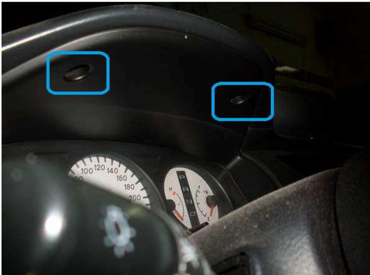
**далее снимаем щиток приборов**
