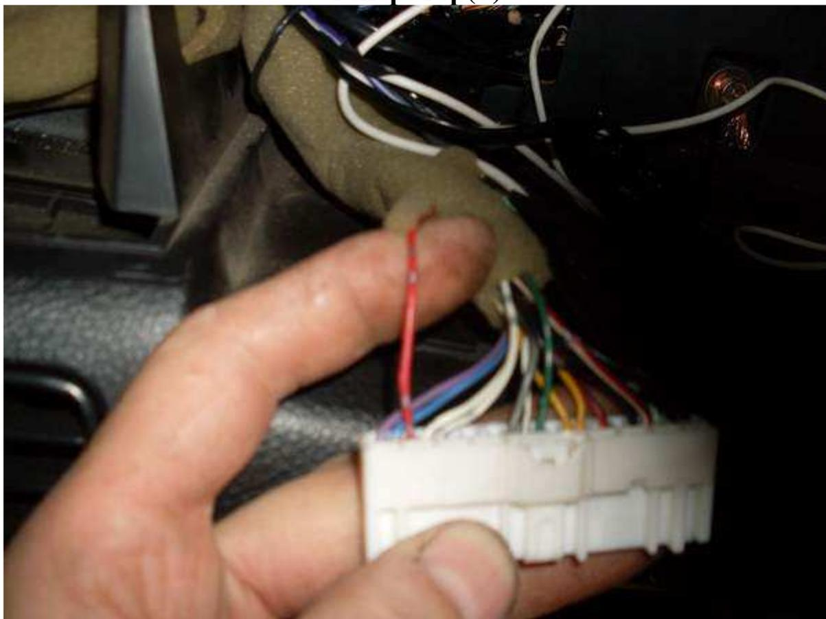
**в левом разъёме красный провод (+) и в этом же разъёме провод поворотов одной стороны светло/зелёный(+) и во втором розовый(+) далее снимаем кожух рулевого вала**
