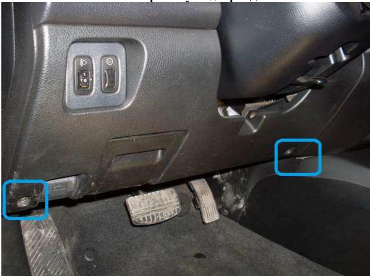
**два самореза снизу . вынимаем мини-бардачёк – за ним ещё
