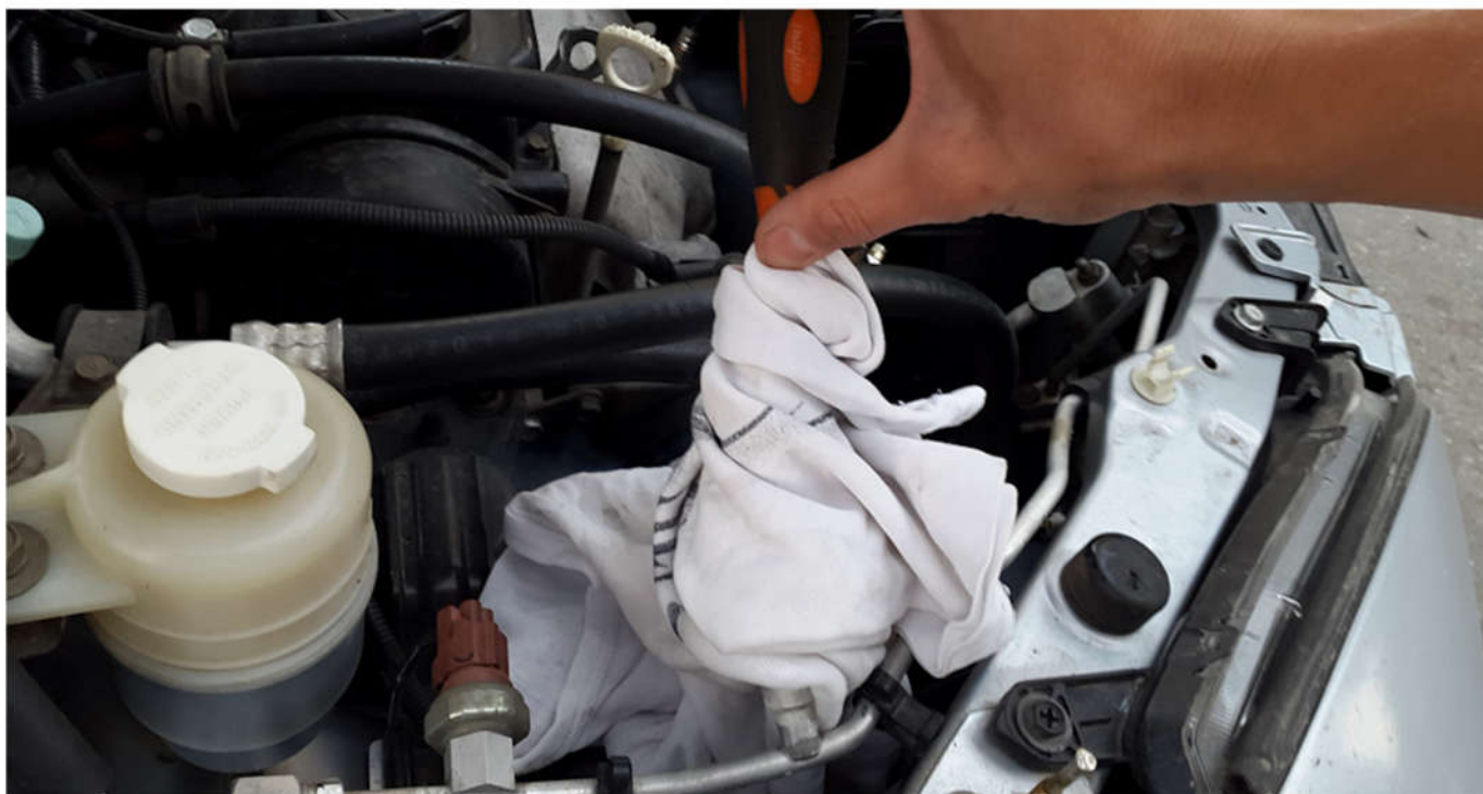
Начинаем с трубки высокого давления. Я делал так: прикладывал тряпку и обматывал ей ниппель и отвертку, и давил отверткой на ниппель. Потом так же до кучи сделал с трубкой низкого давления. Все прошло довольно легко и быстро. Тряпку сразу же выкинул.
