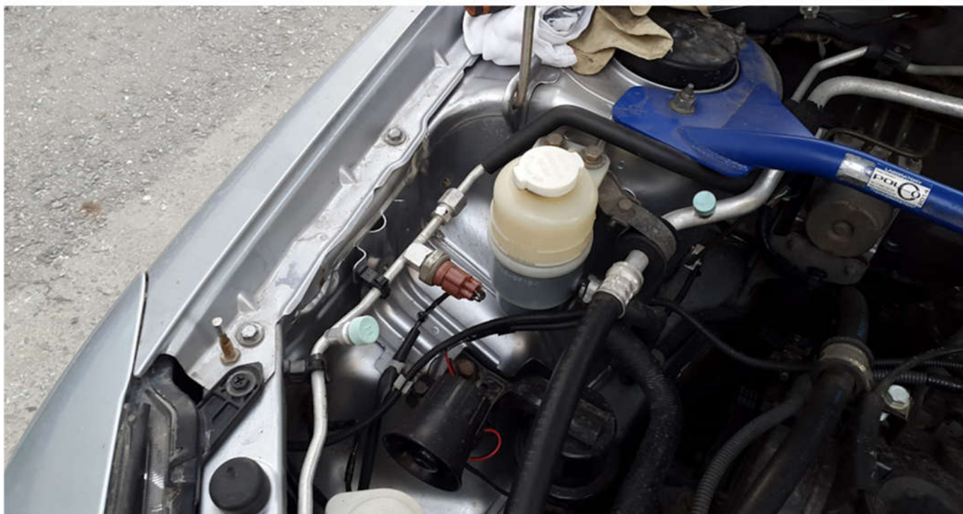
Снимаем колпачки с ниппелей трубок кондиционера и стравливаем фреон
