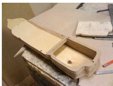
Более тонкая часть ящика зашивается глухой стенкой
