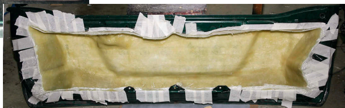
Стеклопластиковая оболочка толщиной 8 мм выклеивается по виброизолированной двери
