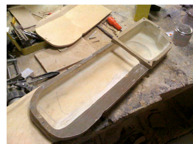
Перед сбор- кой острые углы внутри скруглены
