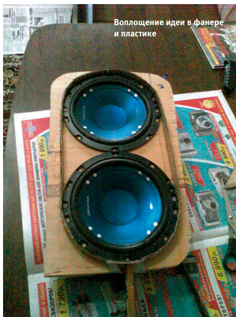
Работа над первыми подиумами: как всегда, сначала — картонный макет
