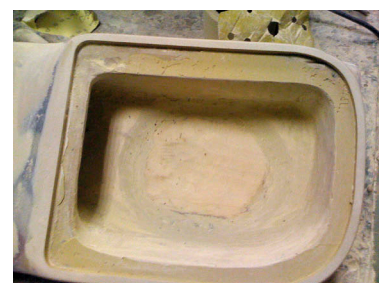
Под магни- том сделано углубление, чтобы не затруднять вентиляцию катушки
