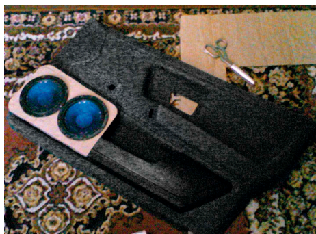
Работа над первыми подиумами: как всегда, сначала — картонный макет
