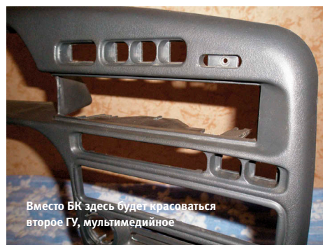
Квадратные метры наждачной бумаги, часы ручной работы, зато головное устройство сидит как влитое
