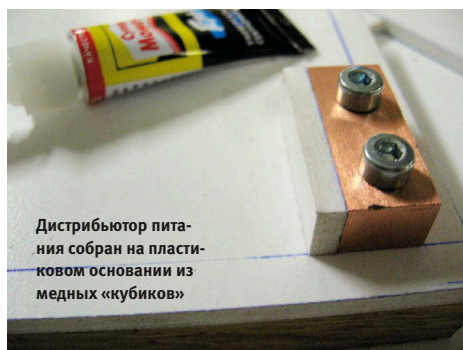
Между собой элементы разделены пластиковыми прокладками
