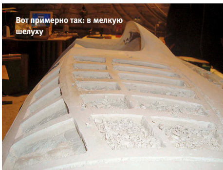
Подготовка к отливке матрицы решёток
