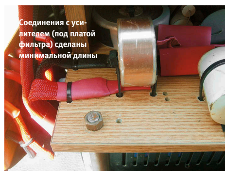
Так много элементов не из-за высокого порядка фильтров, это — фазокорректирующие цепи
