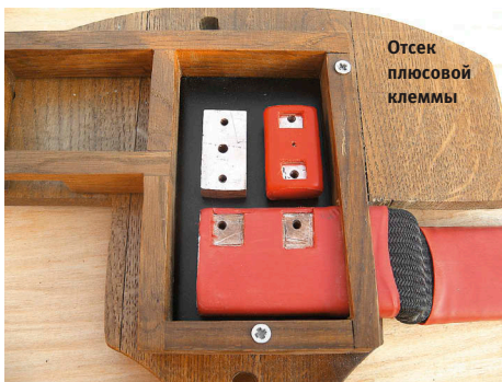
Готовая «станция» с главными предохранителями
