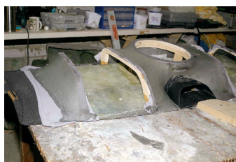
Нервюры задают профиль будущего корпуса, снятый стоп-сигнал резервирует своё же место
