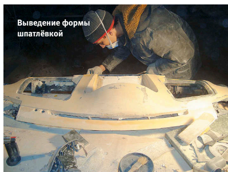
Стеклопластиковые боковины нижней части
