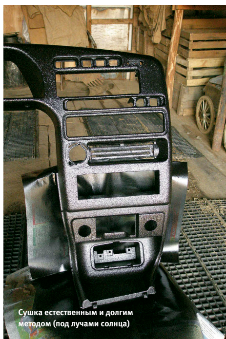
Фактура поверхности создаётся несколькими слоями аэрозольного антикоррозийного покрытия
