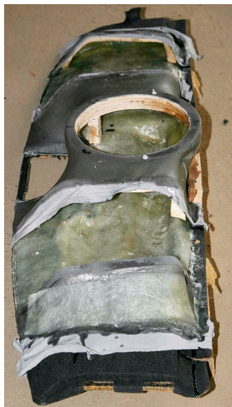
Ткань удобнее наклеивать не сразу всю, а по отсекам
