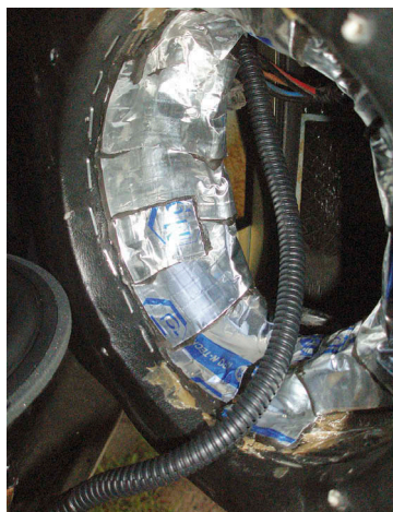
Все щели между подиумом и металлом двери закаты с применением шпательки со стекловолокном
