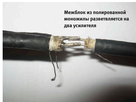
Соединение изолировано хлопком...
