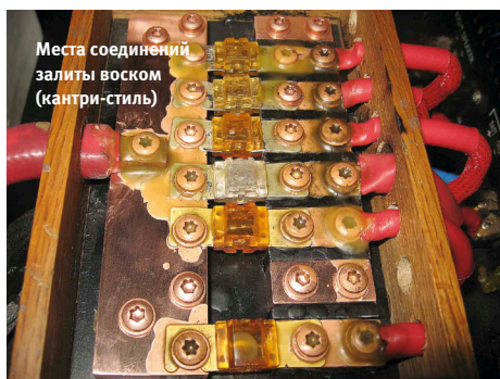
Минусовой дистрибутор, изолированный от кузова
