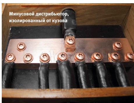
Соединения с усилителем (под платой фильтра) сделаны минимальной длины
