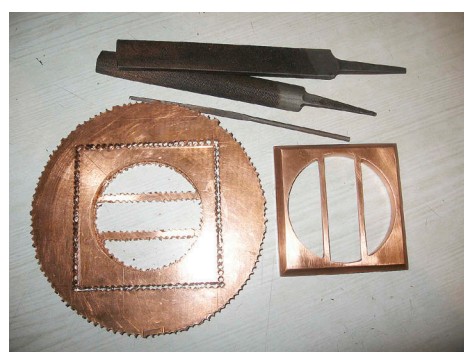
Слева — заготовка. Справа — готовый гриль, рядом — главный инструмент
