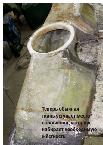
Нервюры задают профиль будущего корпуса, снятый стоп-сигнал резервирует своё же место
