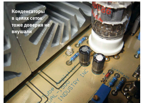
На их место пришли Elna правильного номинала и вольтажа
