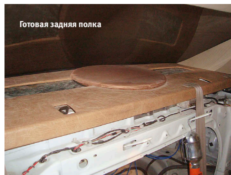
Каркас грилья под обтяжку акустически прозрачной тканью
