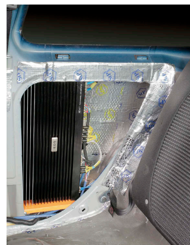
Единственный на всю систему усилитель и тот забрался под боковину салона
