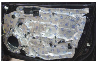
Штатная опора мидбаса оказалась, благодаря рельефной форме, вполне даже жёсткой
