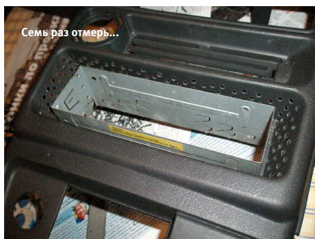
Квадратные метры наждачной бумаги, часы ручной работы, зато головное устройство сидит как влитое
