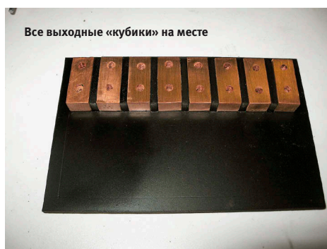
Минусовой дистрибутор, изолированный от кузова
