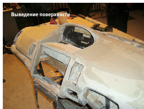
Подготовка к отливке матрицы решёток
