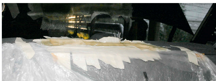
Этап первый: прямо на полке выклеивается основание будущего корпуса
