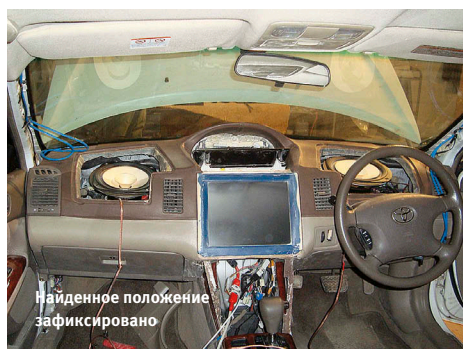
Формование акустического экрана вокруг опорного кольца
