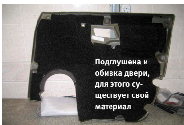
Внутренняя панель герметизирована «Алюмо-бондом» толщиной 5 мм
