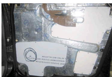
Внутренняя панель герметизирована «Алюмо-бондом» толщиной 5 мм
