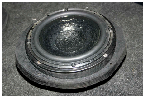
Теперь уже можно ставить динамик. Вот он в сборе с опорой
