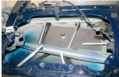
Профили подгоняются по длине и изгибу к панели двери
