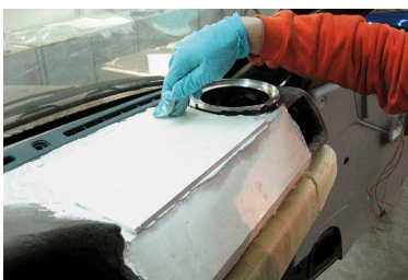
Сверху, на ещё не застывшую «замазку» накладывается раскроенный пластик
