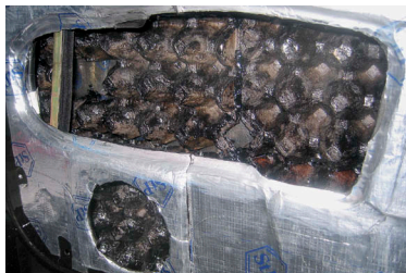
Раскроенные «по сухому» и пропитанные рельефные панели наклеены на панель двери
