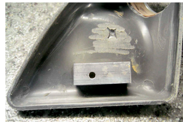
...изнутри внизу приклепан опорный алюминиевый швеллер...
