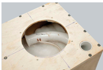
Чтобы настроить ФИ объёмом 4 л на 40 Гц, тоннель, даже при диаметре 3 см, нужен больше 30 см длиной. Потому и кривой...
