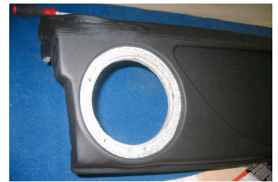
Верх торпедо после обтяжки кожей: всё, кроме закладного кольца
