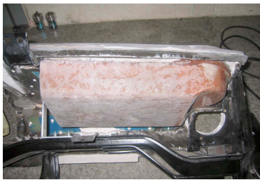
Основа из 12-миллиметровой MDF оклеена стеклотканью на полиэфирке...
