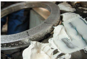
Крепление верхнего закладного кольца: «Поксипол» держится за вкрученные по периферии винты
