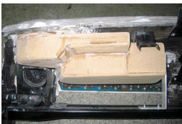
Бокс С4 на примерке к крепёжным узлам
