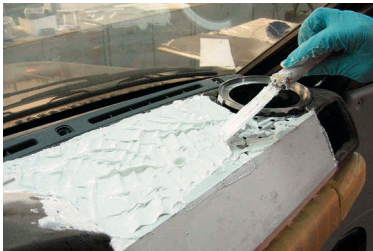
Перфорация нужна для надёжного сцепления с полимерным компаундом
