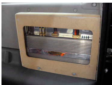
Кожух снимается просто: два фиксатора внизу, две точки подвеса — наверху
