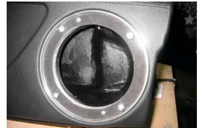
Снизу к кольцу притягивается такое же, заделанное в СЧ-бок
