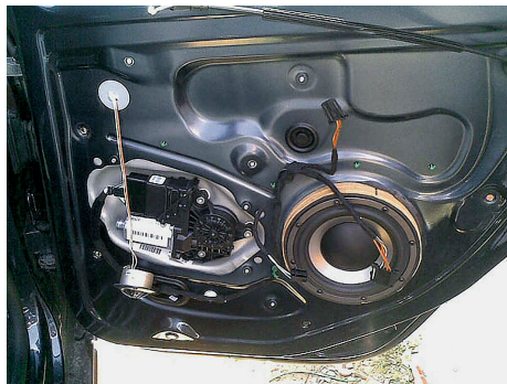
Мидбасы, разумеется, монтировались со стороны салона
