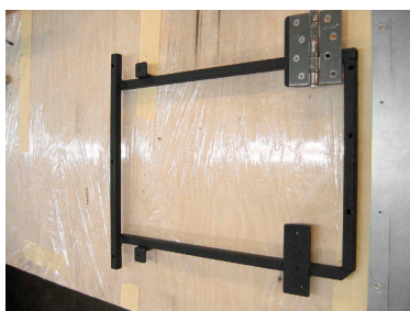
Усилители подвешены к двум сторонам сварной рамы, петли на ней — для откидывания одного из них, «внешнего»
