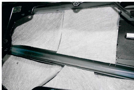
Стекломат раскраивается с нахлёстом на полки профилей
