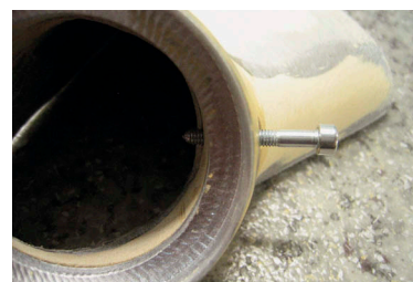
Громоздкие гайки убрали, вместо этого корпус пищалки фиксируется стопорным винтом. Не этим, а коротким и без головки
