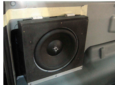
Сабвуфер без внешнего кожуха, до лампочек можно добраться и без его демонтажа
