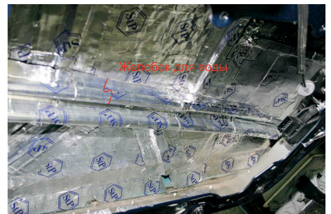
На усилителе панели надо сделать желобок для стока воды. Вода будет, вы видели
