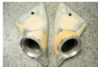
Подиумы для пищалок изготовлены на основе штатных заглушек, снаружи в них заделаны алюминиевые кольца...
