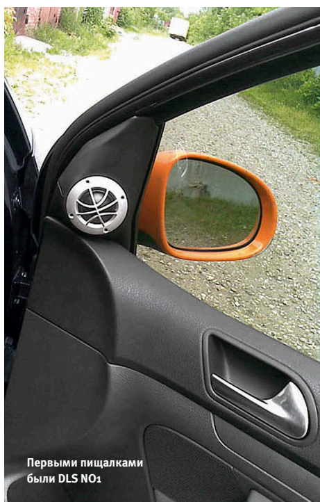
Установка проставок твитеров заливка «Поксиполом»
