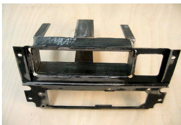
Подиумы для пищалок изготовлены на основе штатных заглушек, снаружи в них заделаны алюминиевые кольца...
