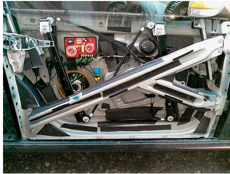
С улицы укладывалась проводка и устанавливались кроссоверы
