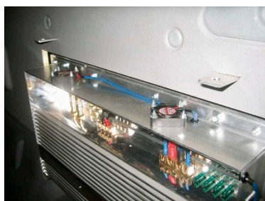
В верхней части алюминиевого короба «внешнего» усилителя установлены вентиляторы охлаждения
