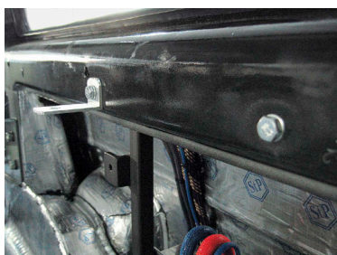
Рама уходит в глубину крыла, а на переднем плане — алюминиевые узлы фиксации защитного кожуха
