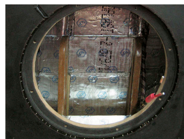
Внутренняя поверхность обработана «виброй»
