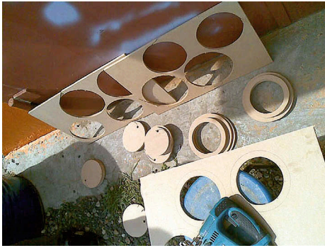
Нарезка заготовок для проставок
