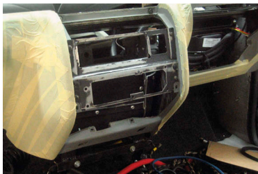
Для установки головного устройства и монитора тоже была изготовлена могучая сварная конструкция. Этой машине не по автобанам ездить...
