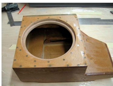
Готовый корпус после обработки смолой
