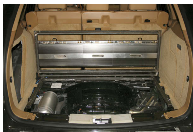
Дополнительный аккумулятор внутри штатной докатки
