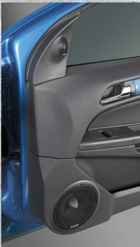
При установке мидбасов ориентацию осей изменили ради- кально
