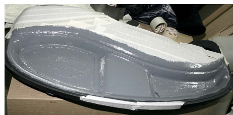
Впрочем, за дело. Шаг первый — слой гель-коута на поверхности «корытца»
