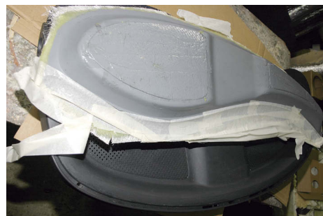
Нижняя часть корпуса фронтальной акустики готова
