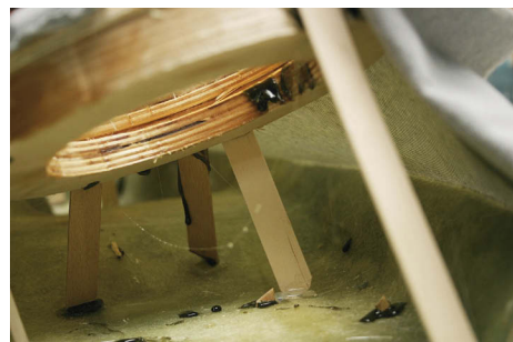
Теперь — верхняя часть. Стойки, на которые опираются кольца, нужны только на этапе обтяжки тканью
