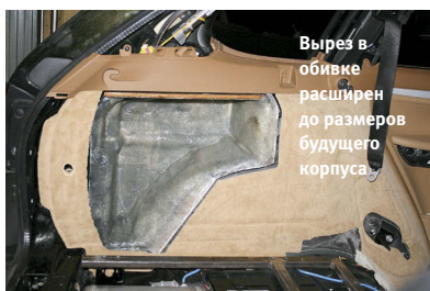
Задняя часть корпуса-«стелса» выклеена по крылу
