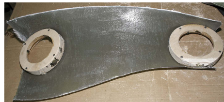
После отвердевания смолы кольца крепятся к верхней оболочке...
