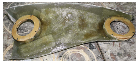
...и окончательно «вживляются» в неё при укладке стекломата изнутри
