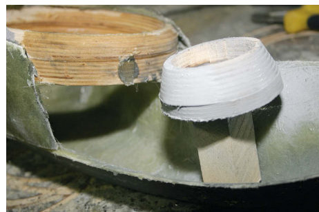
На незашитых пока концах корпуса установлены стаканы пищалок
