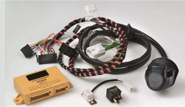
**Комплект электропроводки** состоит из отдельного жгута проводки для фаркопа и модуля контроля напряжения цепи. Отдельный жгут позволяет избежать увеличения напряжения в основной сети автомобиля, а контрольный модуль регулирует напряжение в цепи прицепа и информирует водителя о неисправности ламп фонарей прицепа.
