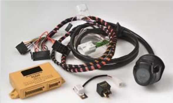
**Комплект электропроводки** состоит из отдельного жгута проводки для фаркопа и модуля контроля напряжения цепи. Отдельный жгут позволяет избежать увеличения напряжения в основной сети автомобиля, а контрольный модуль регулирует напряжение в цепи прицепа и информирует водителя о неисправности ламп фонарей прицепа.
