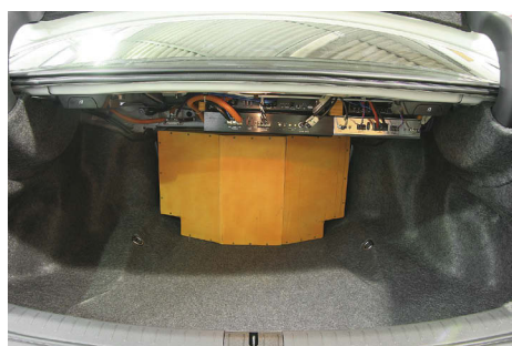
Усилители и сабвуфер до завершения декора, для ясности
