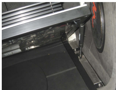
Подъём облегчают газовые пружины
