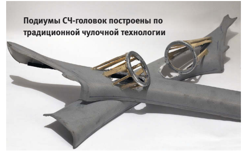
Среднечастотник после окончательной установки. Обратите внимание на вогнутость над динамиком
