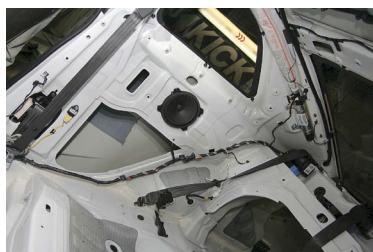
Для установки самых объёмных узлов приготовили задние боковины кузова
