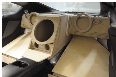
Каркас и основные объёмы выклеены из деревянных фрагментов
