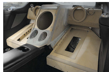
Стеклопластик придаёт агрегату окончательные формы
