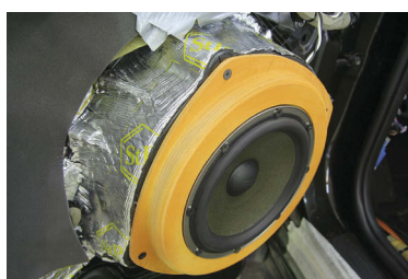
То, о чём Амар Бозе не позаботился: мощная опора для мидбасов и виброизоляция дверей
