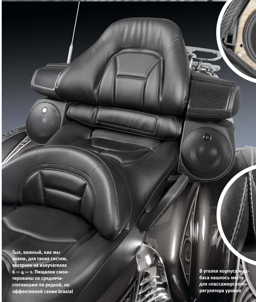
Типология фронтальной акустики 5 — 3 — 1. При этом габариты пищалки и среднечастотника оказались почти одинаковыми
