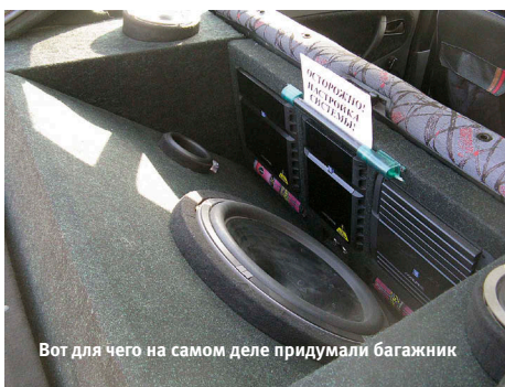
Катушки сабвуфера соединены на 2 Ом, поэтому провод 8 Га — это то что надо
