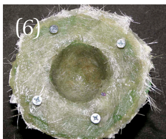
При предварительной сборке матрицы полшарика находится внутри, так будет задана равномерная толщина стенок
