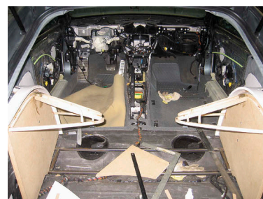
Строительство сабвуферных корпусов: боковые стенки опираются на стальную раму на полу
