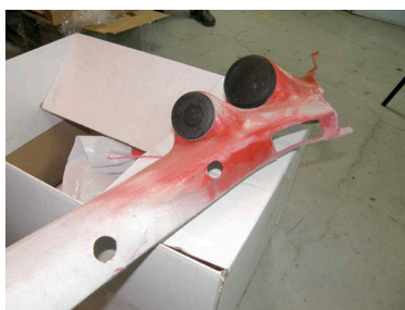
СЧ и ВЧ-головки устанавливались по «текстильной» технологии, но из-за усложнённой формы понадобилось применять отвердевающий пластилин
