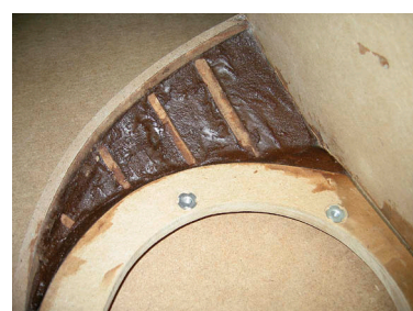
...после чего пространство между ними заполнено шпатлёвкой со стекловолокном
