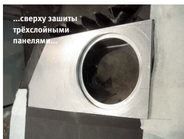
Опорные колодцы для дверных басовиков: алюминий и MDF
