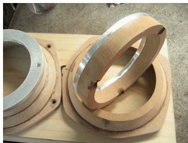
Опорные колодцы для дверных басовиков: алюминий и MDF
