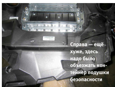
Твёрдой рукой воздуховоды были разрезаны...
