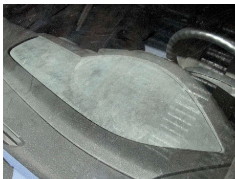
Участок торпедо обтянут алькантарой для уменьшения отражений
