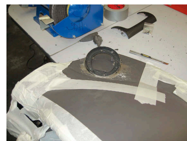
Объём под среднечастотники образовался благодаря наклону опорных колец
