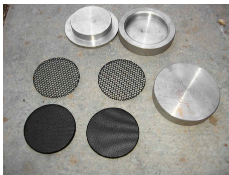
Сетки на среднечастотники были изготовлены новые, повышенной прозрачности
