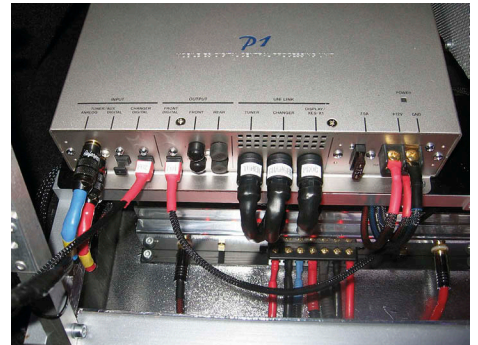
XES P1 — мозг системы, с другими компонентами общается по оптике и шине управления
