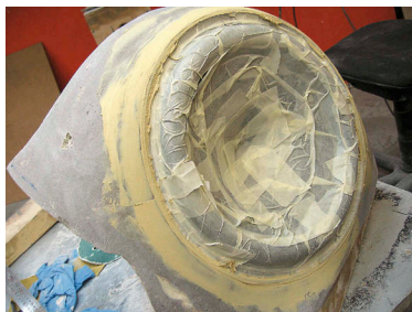
Этапы создания сабвуферных корпусов: стеклопластиковая основа, потом — формирование наружных обводов из пены и наконец — подгонка под динамик
