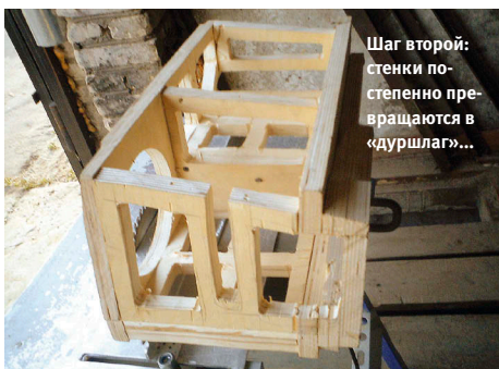
Выбранная конструкция позволила получить лишних полтора литра объёма при отменной жёсткости
