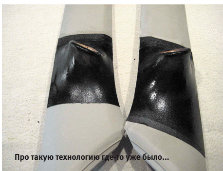
Подиумы для новой установки СЧ-головок, снова стеклопластик...
