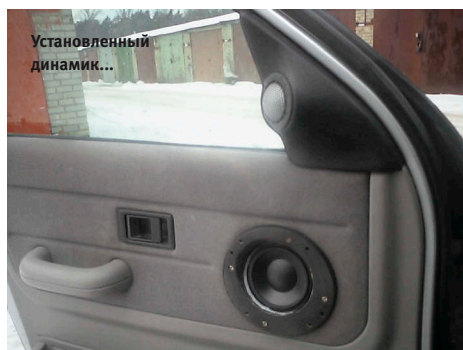
...и надставляется новое, включая мощную алюминиевую опорную плоскость
