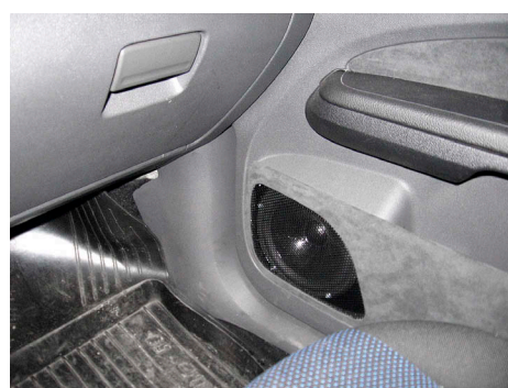
Некоторой доработке подверглась установка мидбасов: поставлен алюминиево-полимерный экран, отштампованы новые сетки, карман перетянут алькантарой
