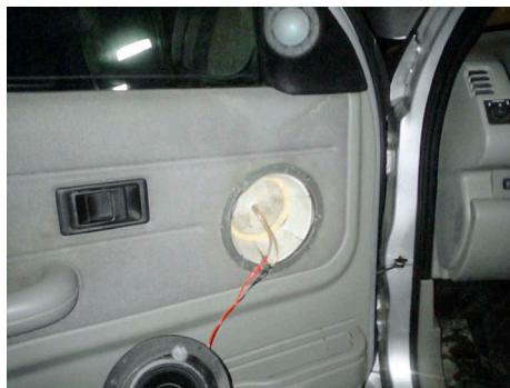
Крышка бокса задаёт и угол наклона оси излучения
