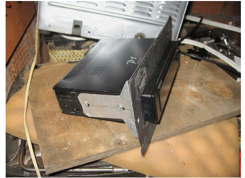
Блок дисплея на алюминиевом кронштейне
