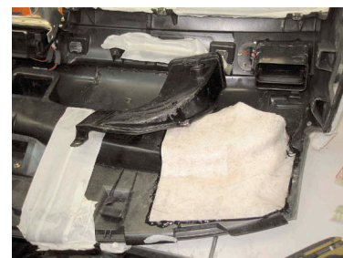
С тыльной стороны объём замыкает стеклопластиковая стенка
