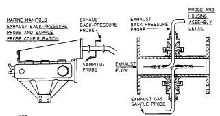
NOTE: THE EXHAUST BACK-PRESSURE AND SAMPLE PROBES MAY BE POSITIONED AT ANY ANGLE AROUND THE CIRCUMFERENCE OF THE HOUSING, PROVIDED. 1. THE EXHAUST BACK-PRESSURE PROBE IS POSITIONED UPSTREAM AND THE EXHAUST GAS SAMPLE PROBE IS POSITIONED DOWNSTREAM 2. THE PROBE & IS COINCIDENT WITH THE PIPE &
