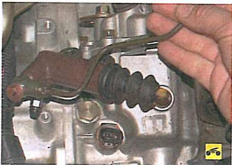
17. ...и отведите в сторону рабочий цилиндр, не отсоединяя от него трубопровод гидропривода выключения сцепления.
