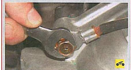
Левым верхним болтом крепления коробки передач закреплен «массовый» провод. При обратной сборке не забудьте установить провод на прежнее место.
