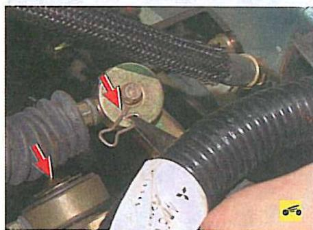
3. Выньте шплинты крепления тросов переключения и выбора передач из отверстий пальцев рычагов механизма переключения передач...
