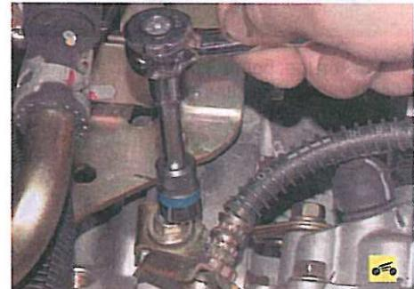
15. Выверните болт крепления к коробке передач кронштейна трубопровода гидропривода выключения сцепления.
