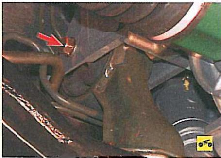
33. Отсоедините заднюю опору силового агрегата от кронштейна коробки передач, отвернув гайку болта ее крепления к кронштейну и вынув болт (см. «Замена задней опоры подвески силового агрегата и кронштейна ее крепления к силовому агрегату», с. 80).
