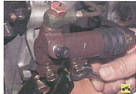
16. Выверните два болта крепления рабочего цилиндра к картеру сцепления...
