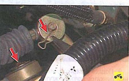
24. Выньте шплинты крепления тросов переключения и выбора передач из отверстий пальцев рычагов механизма переключения передач...
