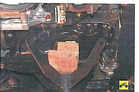
30. Установите под двигатель надежную опору или вывесите его с помощью грузоподъемного механизма.
