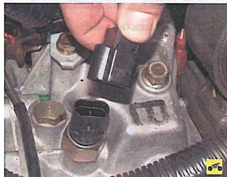
11. Отсоедините колодку жгута проводов от выключателя света заднего хода.
