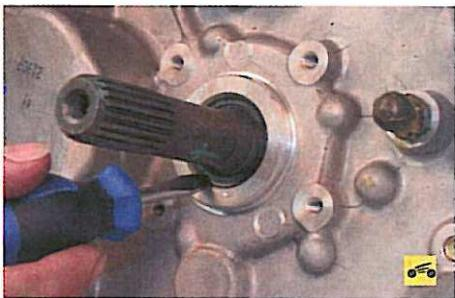
4. С помощью отвертки или крючка из тонкой проволоки выньте сальник. Запрессуйте новый сальник подходящей оправкой. Рабочая кромка сальника должна быть направлена внутрь коробки.
