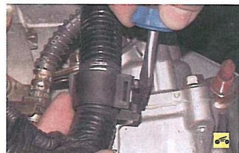
12. Отстегнув отверткой фиксатор...
