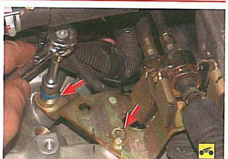
27. Выверните два болта крепления к коробке передач поддерживающего кронштейна тросов...
