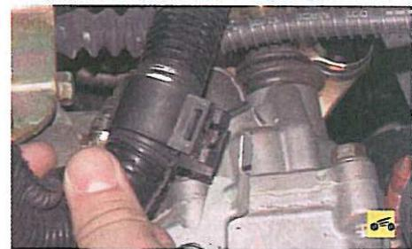
13. ...снимите с кронштейна на коробке передач держатель моторного жгута...
