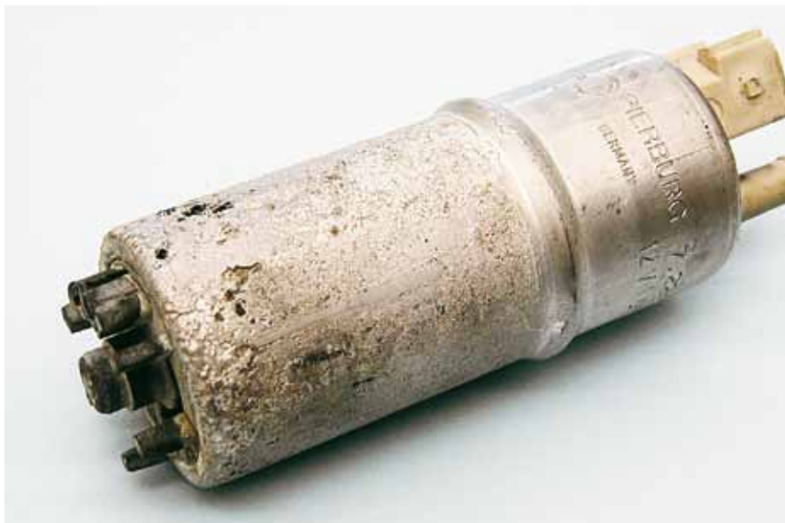
Рис. 72: Контактная коррозия из-за применения неподходящего сочетания материалов
