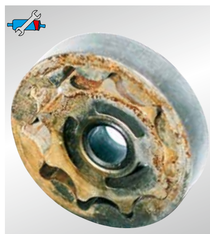
Рис. 53: Для сравнения: заржавевший трохоидный насос. Здесь больше ничего не движется.
