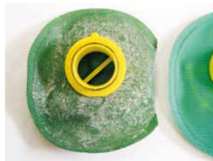
Рис. 42: Слева: отложения извести на фильтре насоса In-Tank; справа: для сравнения новый фильтр
