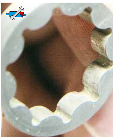
Рис. 51: Трохоидное зубчатое кольцо (слева с известковыми отложениями, справа – новое)
