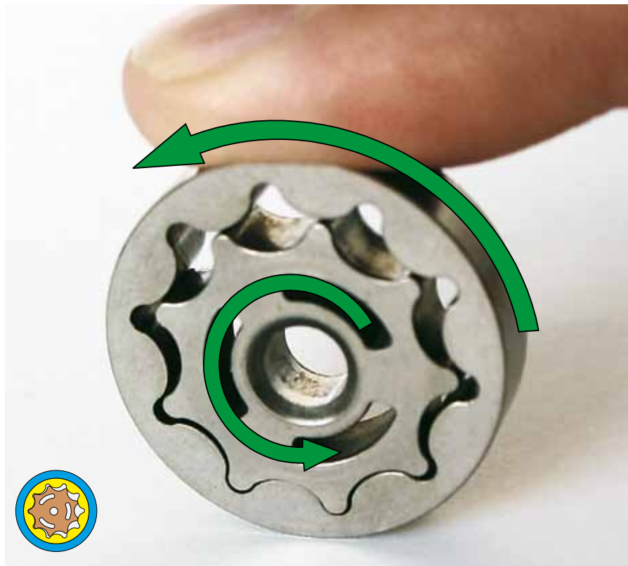
Рис. 52: Части трохоидного насоса должны легко вращаться.
