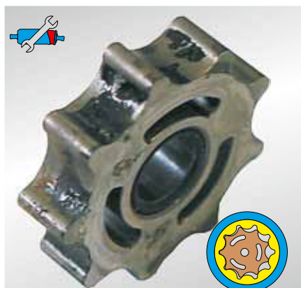
Рис. 32: Уплотнительная масса в насосе (трохоидное зубчатое колесо)
