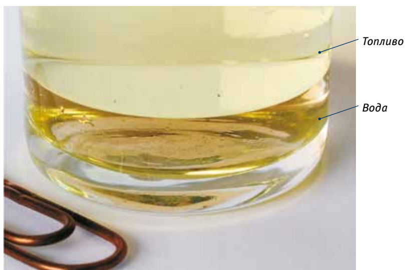
Рис. 39: Вода в топливе
