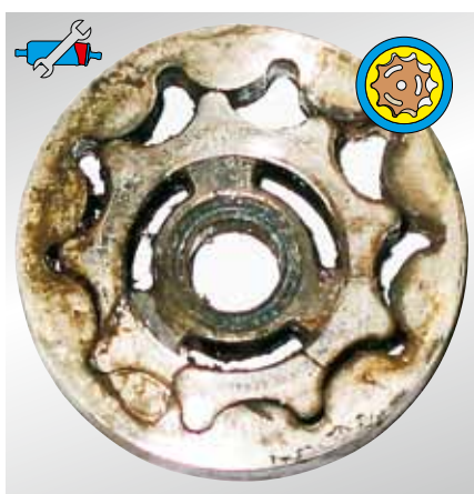
Рис. 19: Блокированный насос (трохоидное шестерённое кольцо) шестерённого насоса E3T
