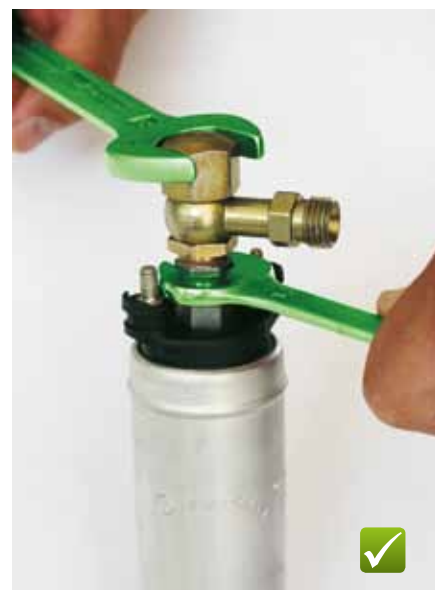
Рис. 71: Правильный монтаж: на нижнем шестиграннике топливного насоса необходимо законтрить.
