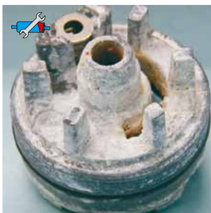
Рис. 50: Заизвесткованный наружный подшипник топливного насоса
