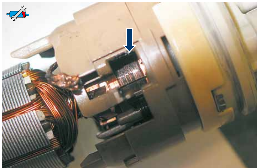
Рис. 61: Взгляд на держатель скользящих контактов Угольные щетки полностью растворены и образуют отложения на реверсоре.
