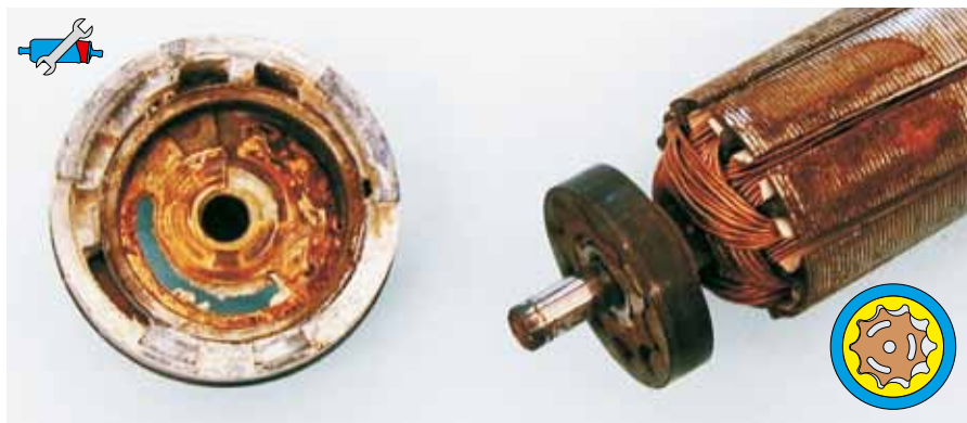
Рис. 37: Шестерёнчатый насос E3T – с отложениями ржавчины и извести
