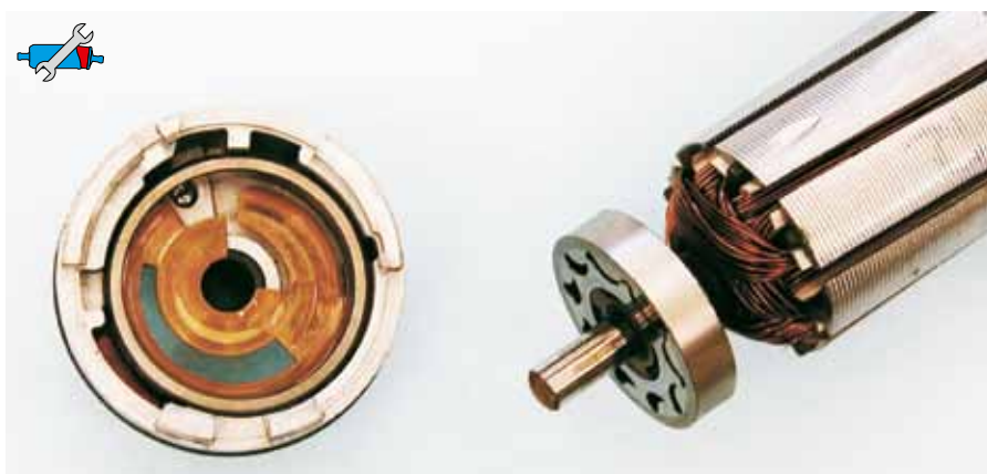
Рис. 38: Для сравнения: Шестерёнчатый насос E3T – в хорошем состоянии, несмотря на большой пробег
