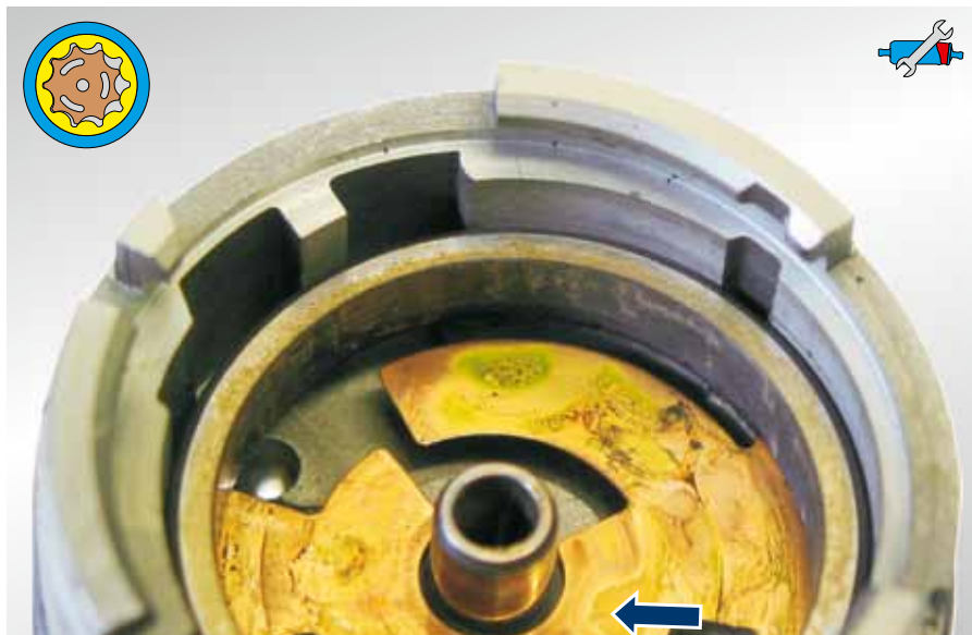
Рис. 59: Склеенный насос Вращающаяся шайба прочно склеилась с механизмом трохоидного насоса. На рисунке насос удалён – его очертания, однако, ещё хорошо видны в клейкой массе.
