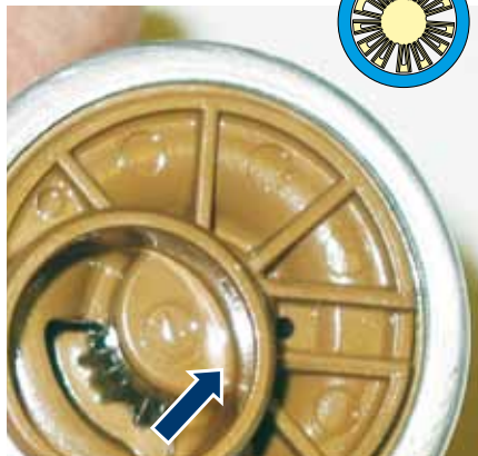
Рис. 34: Рёбра рабочего колеса лопастного насоса с боковым каналом типа E1S разрушены посторонним предметом (слева). Обломки (справа) находились в фильтре.
