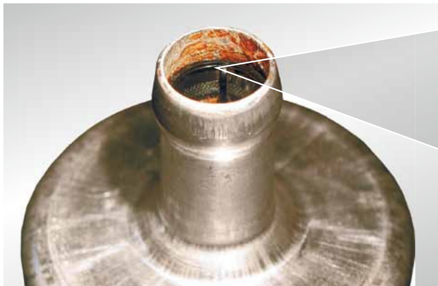
Рис. 40: Заржавевший вход шибберного пластинчатого насоса E1F
