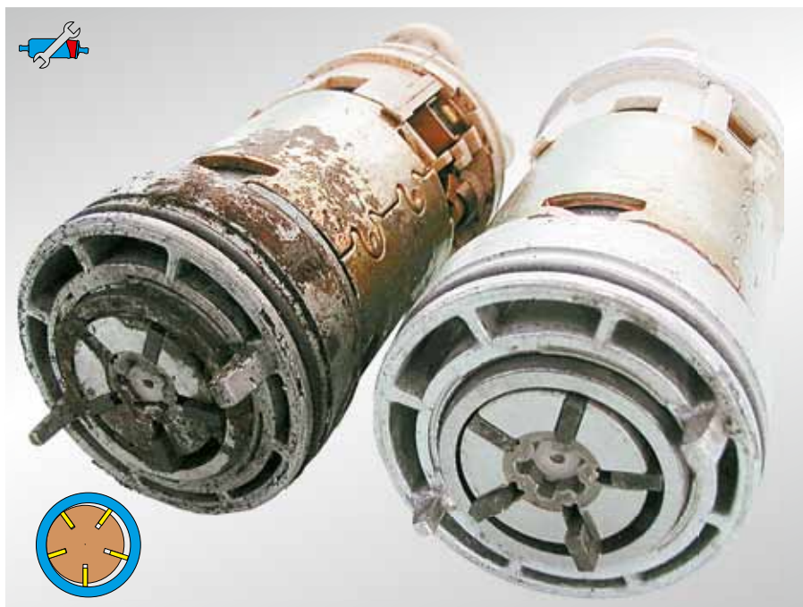
Рис. 36: Повреждения от воды на шибберном пластинчатом насосе Справа для сравнения топливный насос, который не был подвержен действию воды, с приблизительно таким же пробегом.
