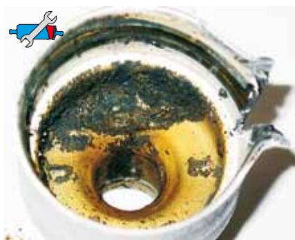
Рис. 18: Взгляд в разрезанный корпус шестерённого насоса E3T, забитого отложениями
