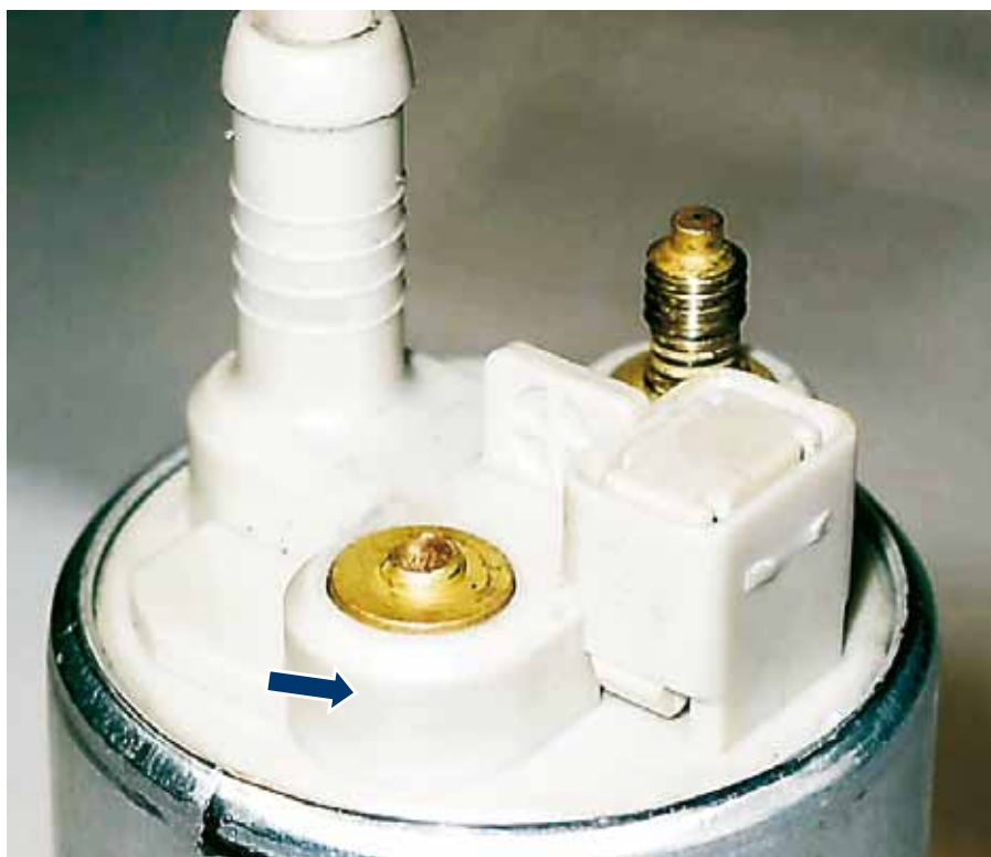
Рис. 75: Повреждение от воздействия силы на электрические контакты
