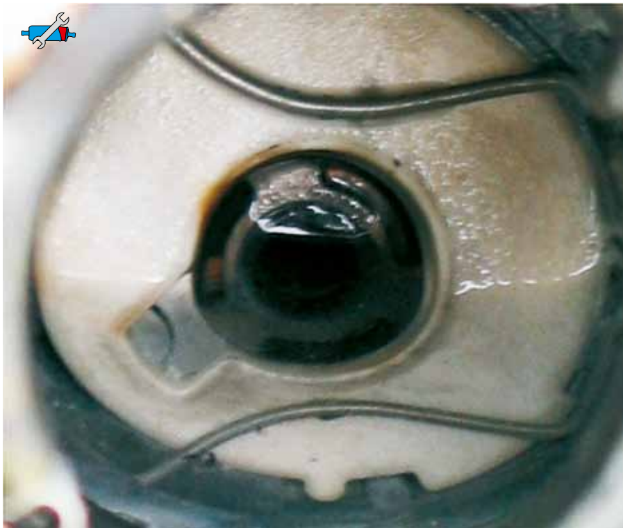
Рис. 44: Вода в топливном насосе В данном случае вода буквально «стояла» в насосе. Насос был подвержен такой сильной коррозии, что вода больше не вытекала. Данный топливный насос был неверно использован как «водяной насос».
