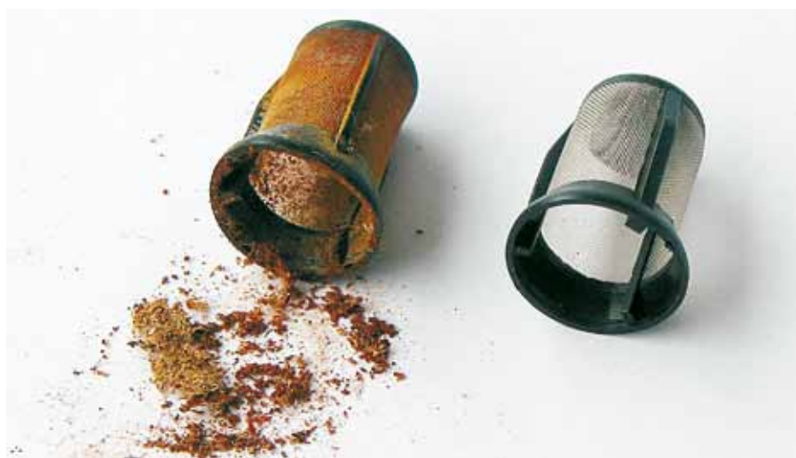
Рис. 41: Слева: забитый ржавчиной сетчатый фильтр; справа: новый сетчатый фильтр
