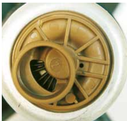
Рис. 34: Рёбра рабочего колеса лопастного насоса с боковым каналом типа E1S разрушены посторонним предметом (слева). Обломки (справа) находились в фильтре.
