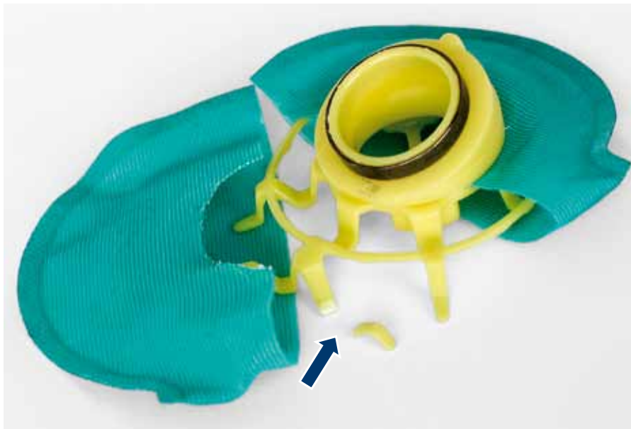
Рис. 76: Сломанные ребра жесткости в фильтре насоса In-Tank
