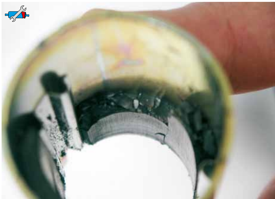
Рис. 80: Разбитый постоянный магнит (статор)
