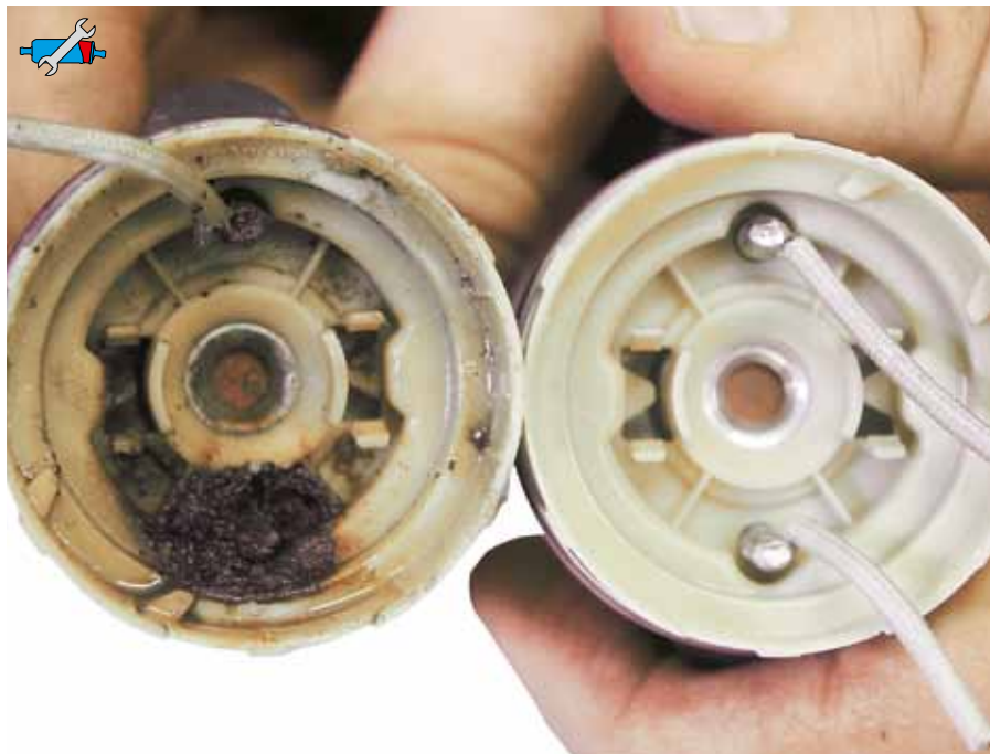
Рис. 46: Слева: корродированные электрические контакты; справа: в новом состоянии
