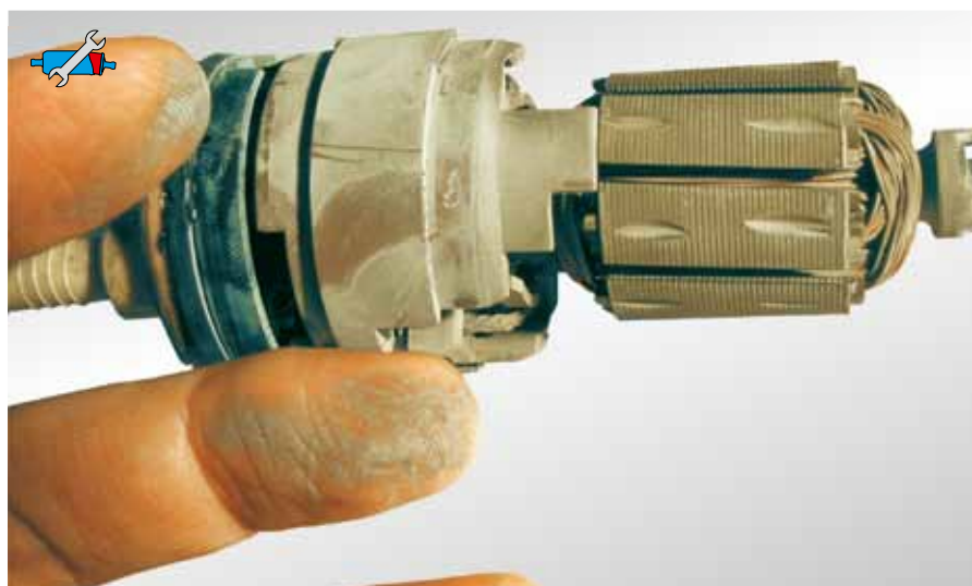
Рис. 56: Отложения из-за топлива недостаточного качества
