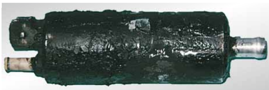
Рис. 65: Насос In-Line, применявшийся как насос In-Tank
