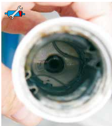
Рис. 44: Вода в топливном насосе В данном случае вода буквально «стояла» в насосе. Насос был подвержен такой сильной коррозии, что вода больше не вытекала. Данный топливный насос был неверно использован как «водяной насос».
