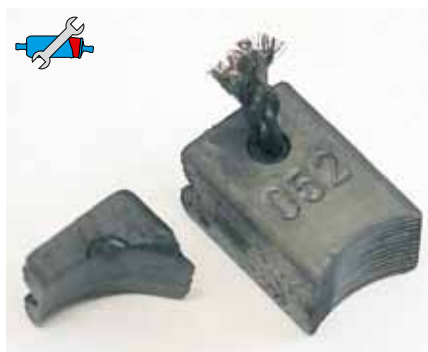
Рис. 62: Скользящие контакты при пробеге ок. 15 000 км. Слева: преждевременно изношенные; справа: нормальное состояние при данном пробеге
