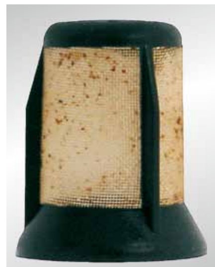
Рис. 23: Загрязнённый сетчатый фильтр шестерёнчатого насоса E3T
