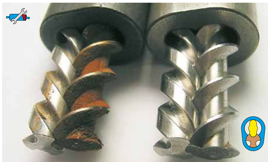
Рис. 54: Винтовой насос (слева – заржавевший, а справа – новый)
