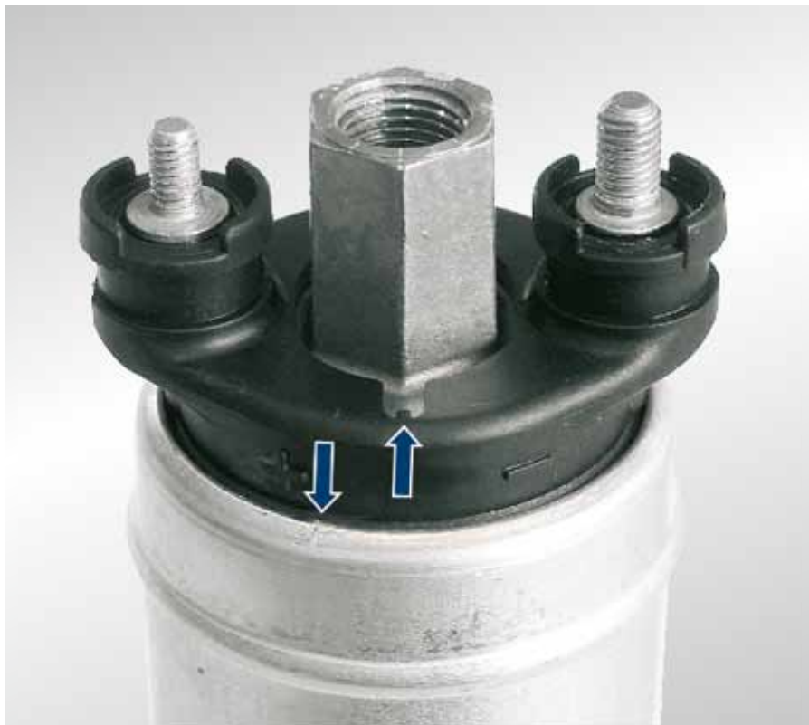
Рис. 69: Перевернутая крышка насоса На топливных насосах типов E2T и E3T нанесены маркировки. Данные маркировки должны находиться друг против друга. Если это не так, то с насосом неправильно обращались и, тем самым, повредили его.
