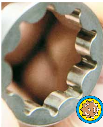
Рис. 50: Заизвесткованный наружный подшипник топливного насоса
