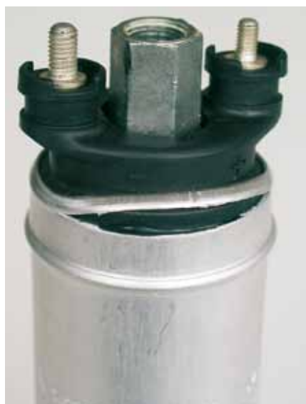
Рис. 1: Повреждения от воздействия силы Не всегда повреждение так очевидно.
