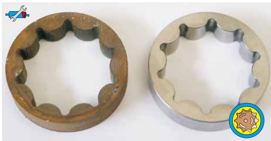
Рис. 48: Слева: сильно заржавевшее трохоидное зубчатое кольцо; справа: в новом состоянии
