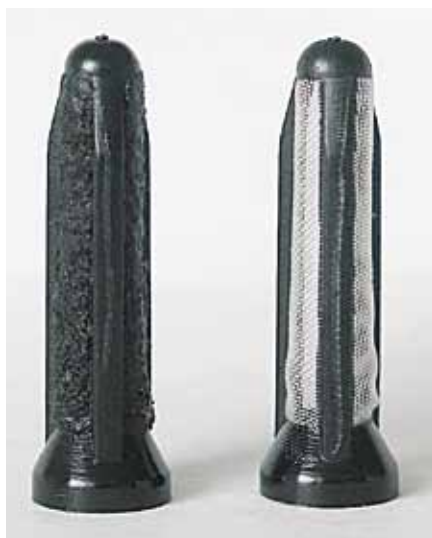
Рис. 22: Сетчатый фильтр шибберного пластинчатого насоса E1F слева забит – справа новый
