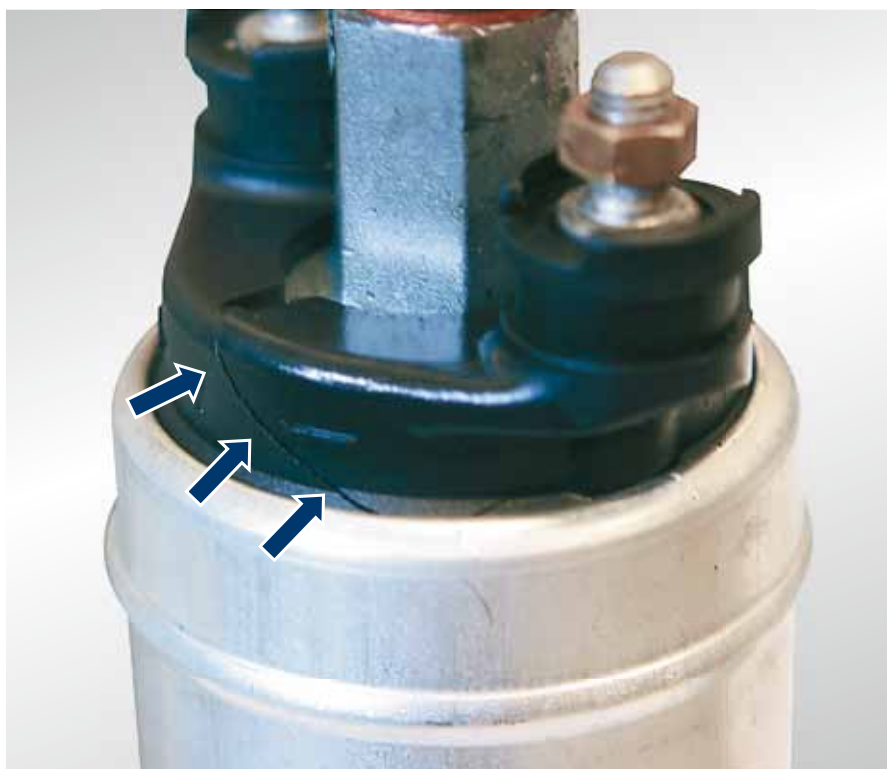
Рис. 73: Повреждение от воздействия силы на корпус
