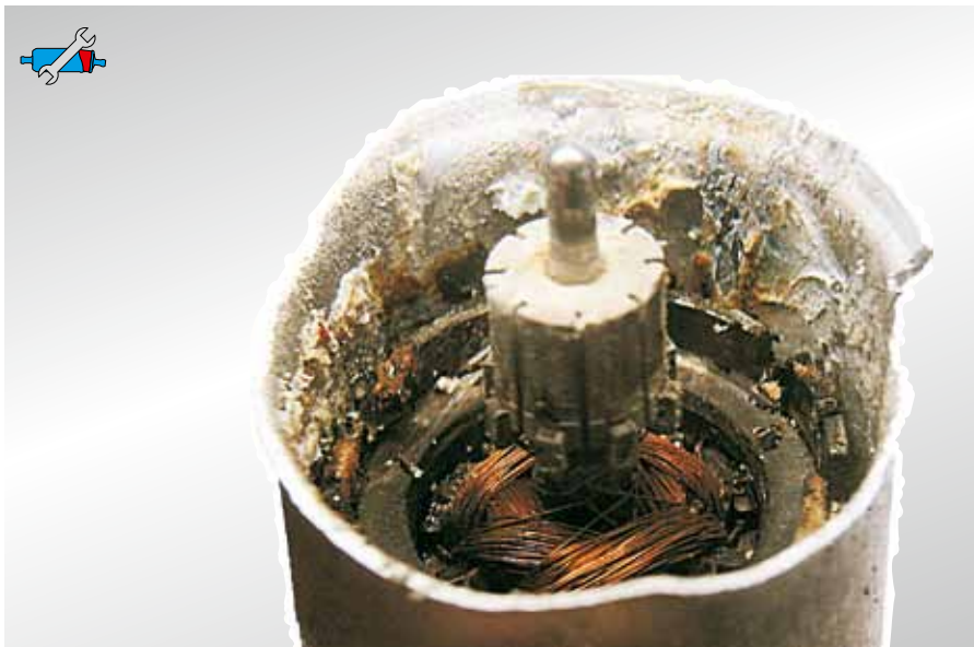
Рис. 16: Сильно корродированный электрический топливный насос. Изображение, которое мастерская, как правило, не получает. Во многих случаях только открытие топливного насоса позволяет определить, почему внешне исправный насос вышел из строя.
