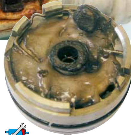
Рис. 21: Из-за работы всухую пластмассовые детали в топливном насосе расплавились.
