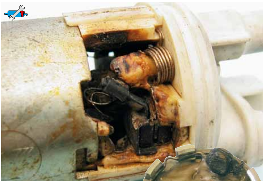
Рис. 20: Повреждения из-за расплавления в результате работы всухую
