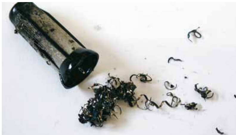
Рис. 29: Опилки в сетчатом фильтре Здесь металлические опилки попали в топливный бак при работах на топливной системе. Опилки с острыми краями повредили сетчатый фильтр. Из-за этого грязь может проникнуть в насос и заблокировать его.
