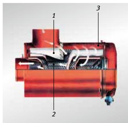
Многоступенчатый воздушный фильтр для грузового автомобиля
