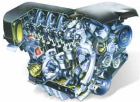
Разрез двигателя внутреннего сгорания
