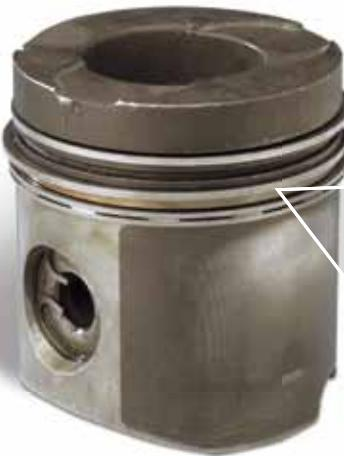
Поршень с явными следами износа.
