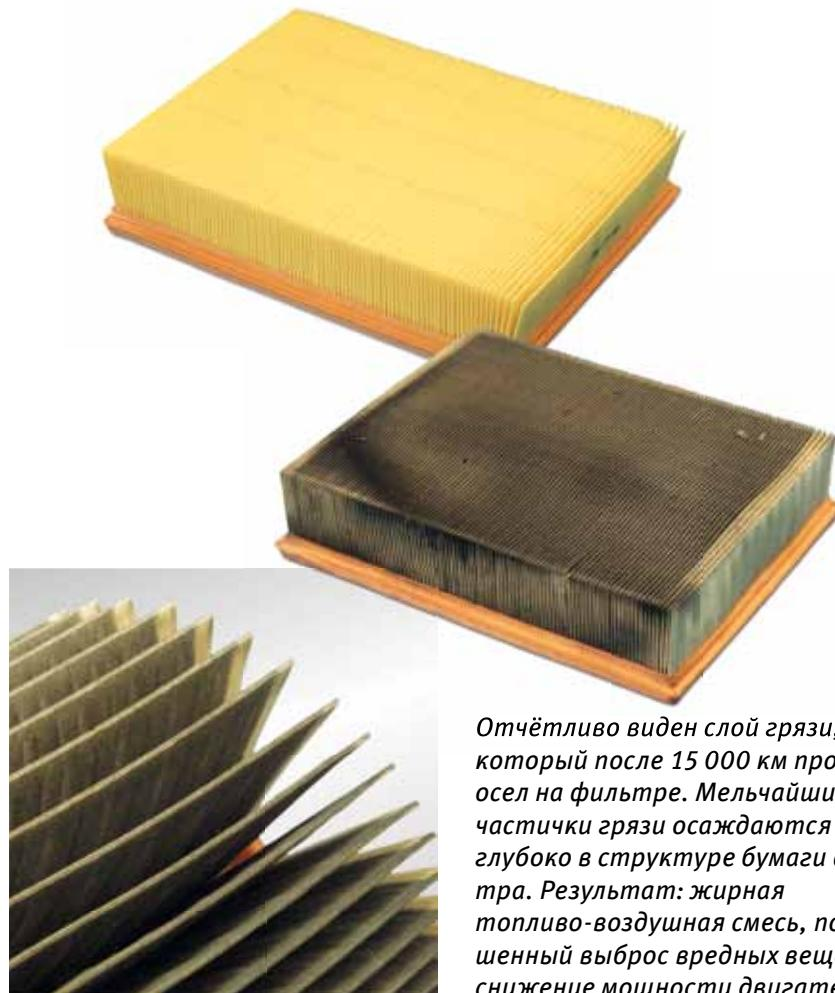
Отчётливо виден слой грязи, который после 15 000 км пробега осел на фильтре. Мельчайшие частицы грязи осаждаются глубоко в структуре бумаги фильтра. Результат: жирная топливо-воздушная смесь, повышенный выброс вредных веществ, снижение мощности двигателя.
