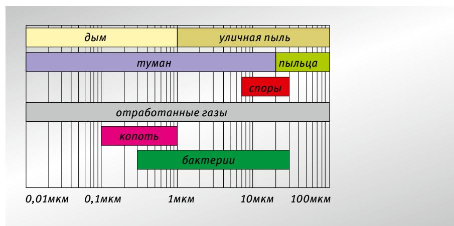
Порядок размеров различных частиц
