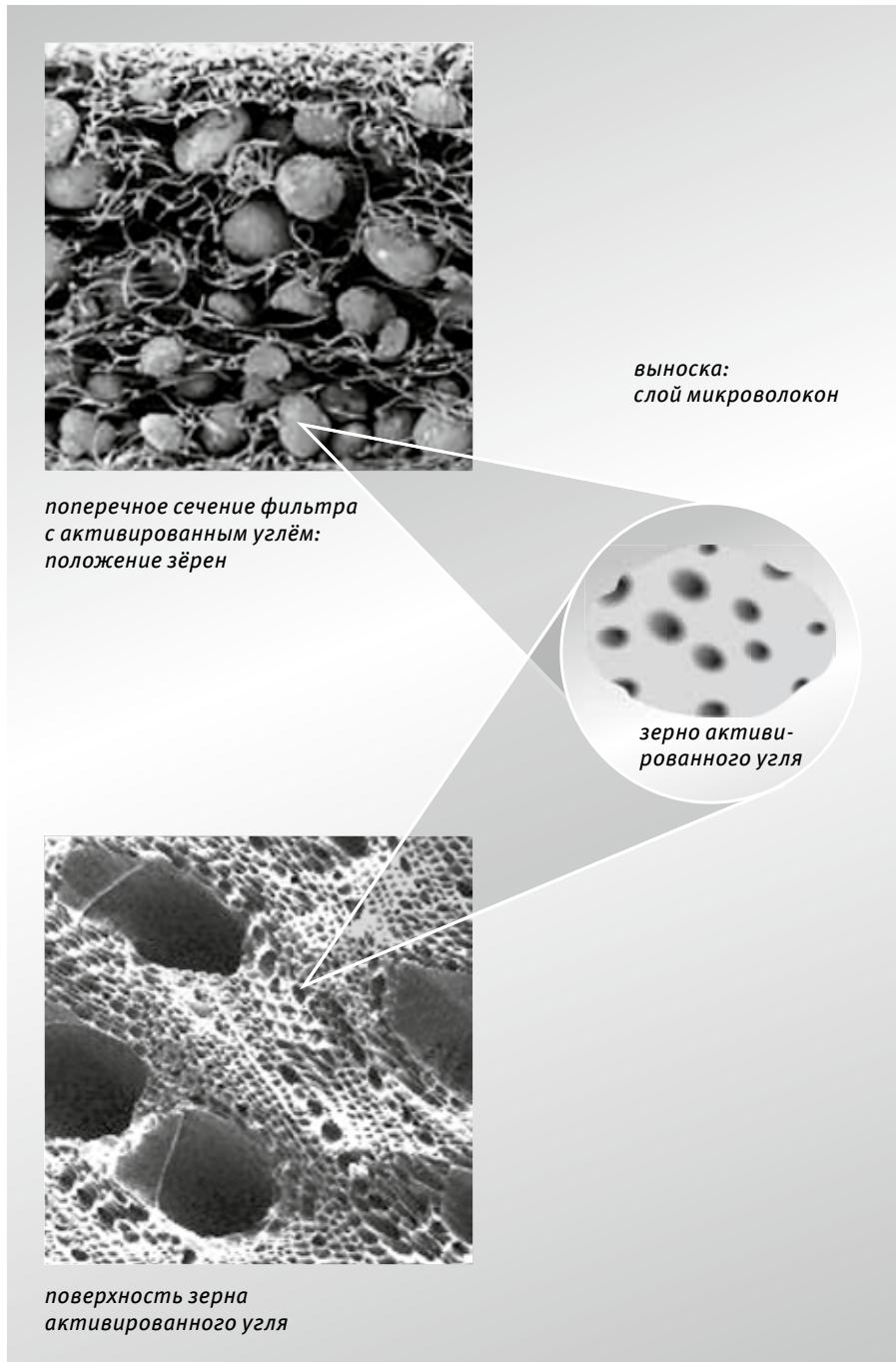
Положение и поверхность зерна активированного угля
