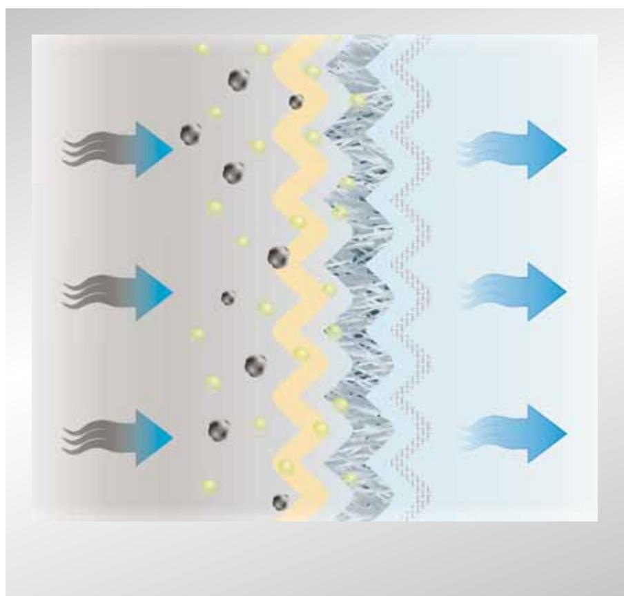
Принцип работы фильтра с активированным углём (комбинированного фильтра)
