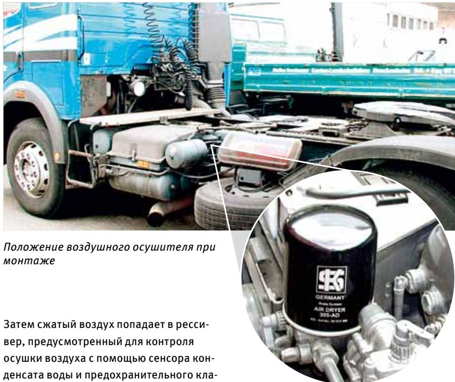
Положение воздушного осушителя при монтаже
