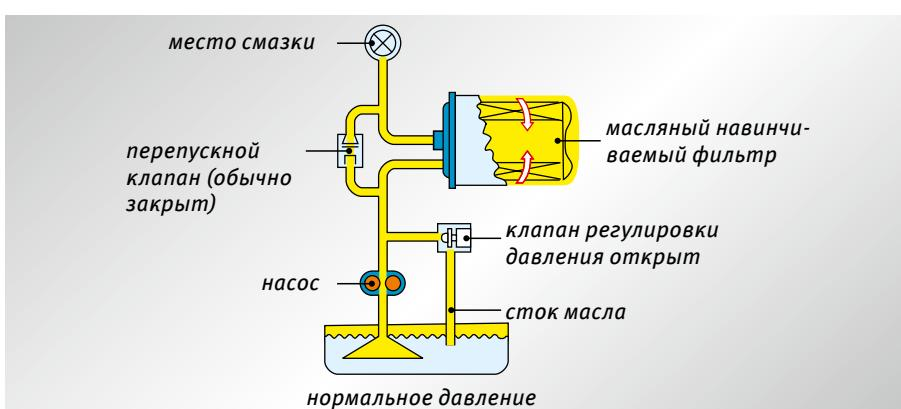
Функциональная схема системы смазки
