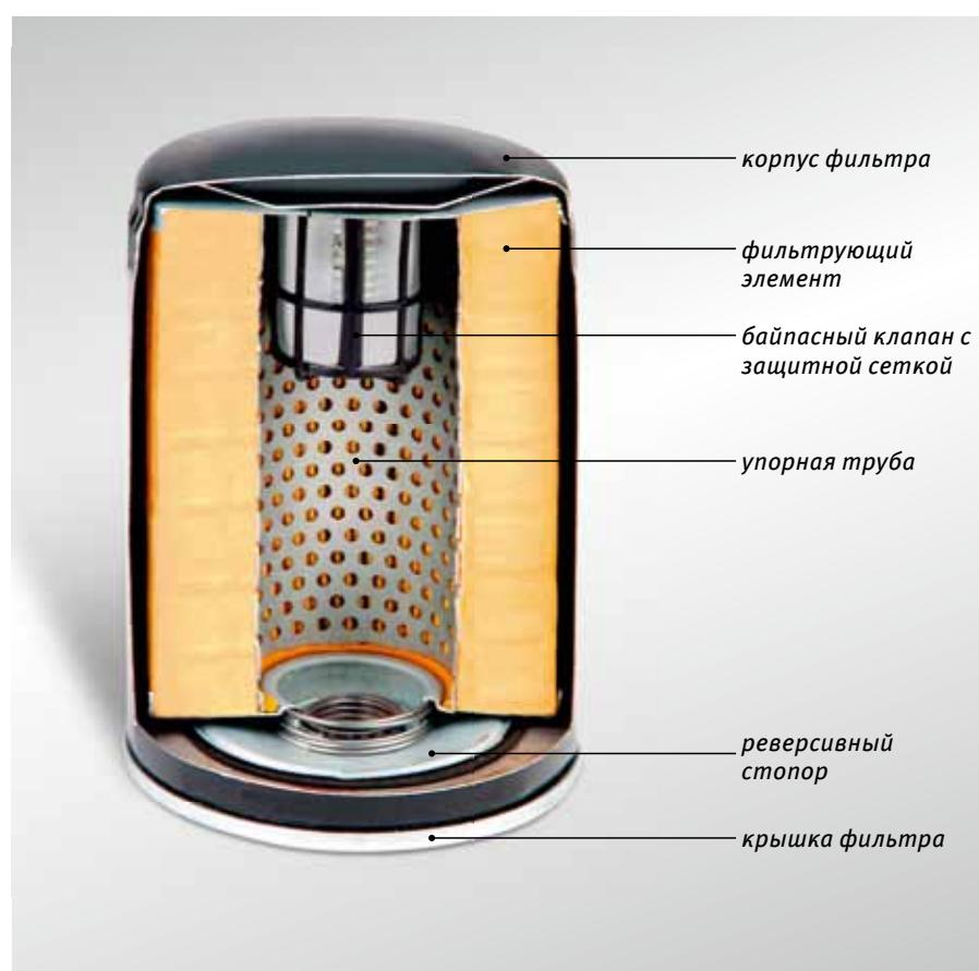
Конструкция масляного навинчивающегося фильтра
