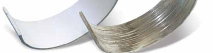
Сильное образование царапин на коренном подшипнике, возникшее из-за смазочной шлифовальной массы, состоящей из масла и пыли.
