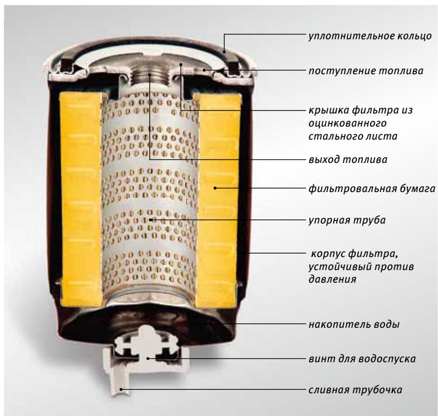
Конструкция дизельного навинчивающегося фильтра
