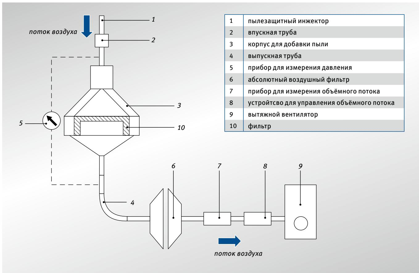
Система испытания для определения степени оседания
