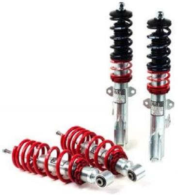
Mit der Verwendung von hochwertigen 1-Rohr-Gasdruckstossdämpfern mit gekürztem Dämpfergehäuse zur Erreichung von grösseren Restfederwegen realisiert H+R eine optimale stufenlose Höhenverstellung im eingebauten Zustand.
