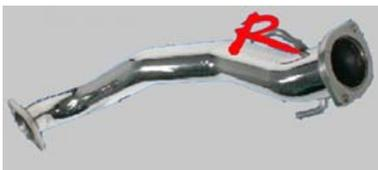
Bessere Abgasabführung, geringerer Staudruck. Dadurch um ca. 10 PS höhere Leistung. Da der Vorkat nicht mehr vorhanden ist, erscheint die Check Engine Lampe. Dies kann durch den Einbau des Lambdasonde Simulator mit der Nummer "O2 Sim" umgangen werden.
