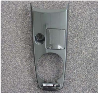
Mittelkonsole Abdeckung in Carbondesign mit Aschenbecher.
