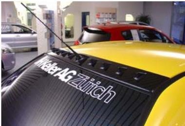
Vortex Generator für die verbesserte Aerodynamik durch
