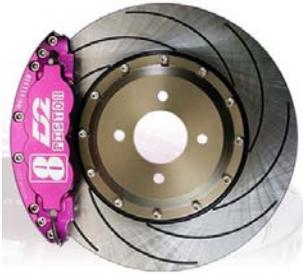
D2 Racing Sport 8-Kolben Hochleistungsbremsanlage mit 330mm Bremsscheiben für 17" Felgen und grösser.
