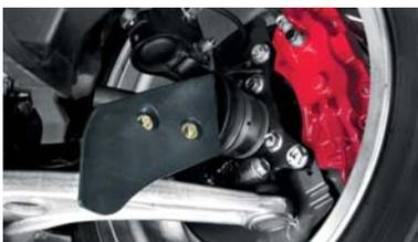
Bremsluftkanal für zusätzliche Kühlung der vorderen Bremsen. Verringert das Bremsfading bei erhöhter Beanspruchung der Bremsen.
