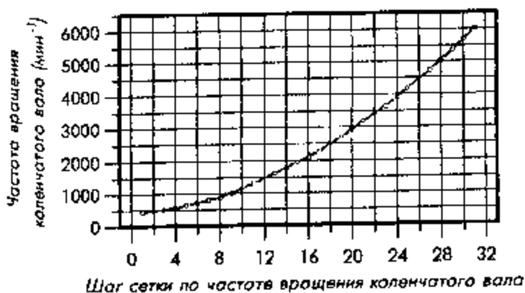
Рис. 8.2.7 Тарифовая зависимость частоты вращения коленчатого вала от положения в сетке таблицы.
