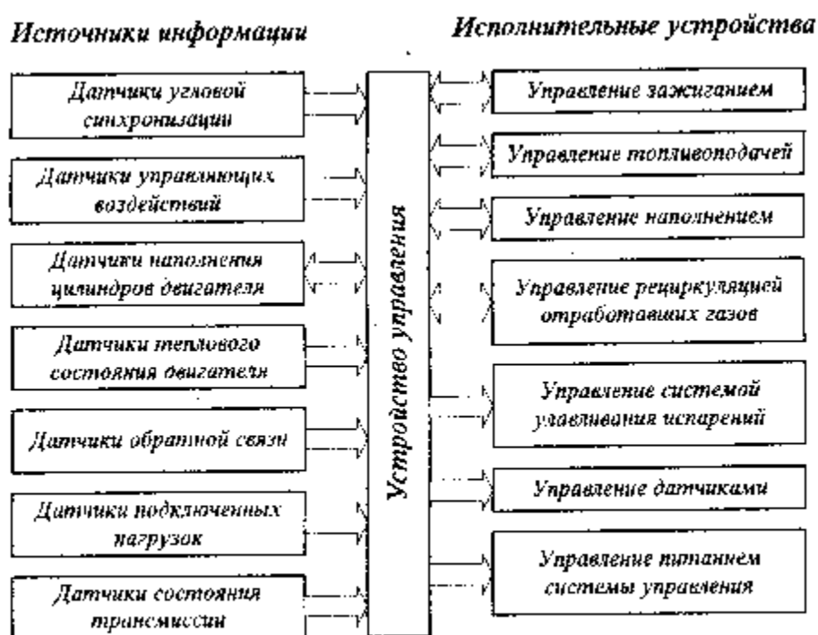
Рис. 1.3.1 Структура системы управления рабочим процессом автомобильного двигателя
