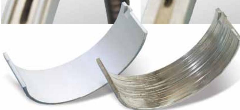
*Сильное образование царапин на коренном подшипнике, возникшее из-за смазочной шлифовальной массы, состоящей из масла и пыли.
