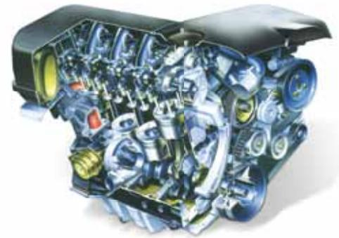
*Разрез двигателя внутреннего сгорания*
