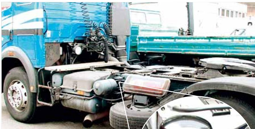
*Положение воздушного осушителя при монтаже*
