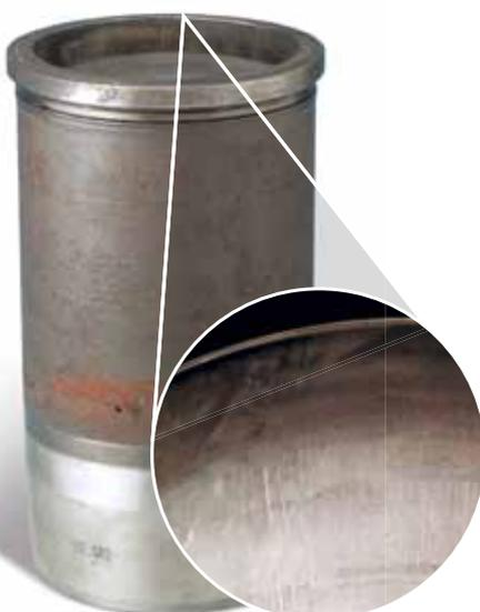
Новая гильза цилиндра с хорошо заметным крестообразным шлифом. Эта поверхность, обработанная хонинговальным инструментом, улучшает адгезионную способность масла на внутренней стенке цилиндра.
