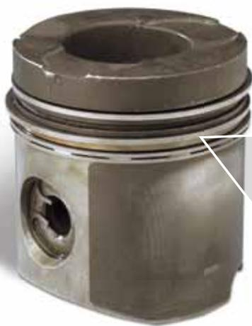
Поршень с явными следами износа. Сильное стирание графитового слоя на юбке поршня. Отсутствие тонкого рабочего слоя может привести к проскальзыванию поршня, в худшем случае к задирам поршня.
